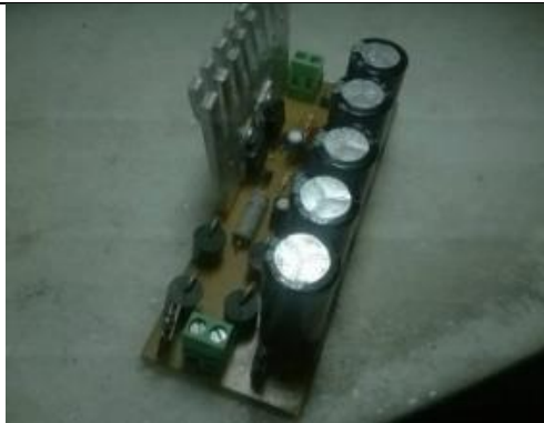
Figura 3 - Placa de circuito Fonte Retificadora
