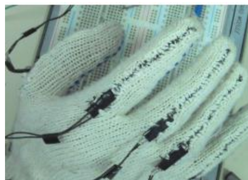
Figura 2 – Fixação do sensor FLEX na luva
