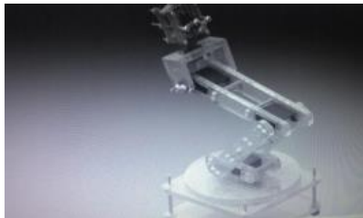
Figura 5 – Primeira versão do braço com três articulações e detalhe de punho levantado Fonte: Os autores
