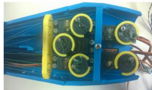
Figura 6 – Disposição dos servos motores na estrutura
