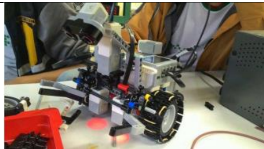
Figura 1- teste de tração com rodas e esteiras em conjunto.
