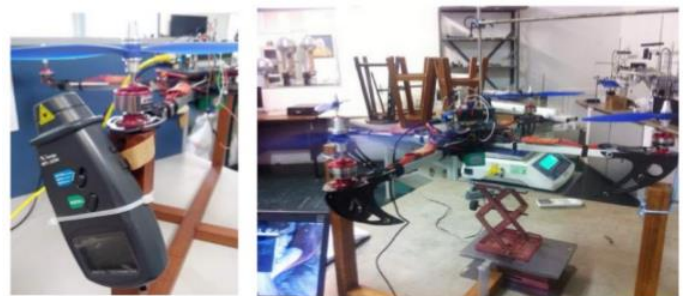
Figura 3 – Experimento da velocidade angular a direita e de Força a esquerda.
