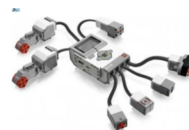
Figura 3. Detalhes do kit EV3, apresentando o controlador conectado a seus sensores e motores.
