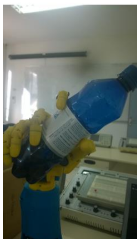
Figura 7 – Mão robótica segurando garrafa pet
