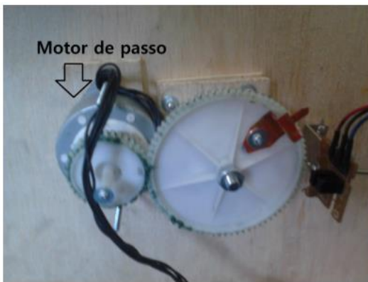
Figura 4- Mecanismo para fazer o protótipo girar.
