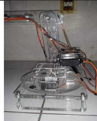
Figura 7 – Segunda versão do braço com dois servos espelhados Fonte: Os autores
