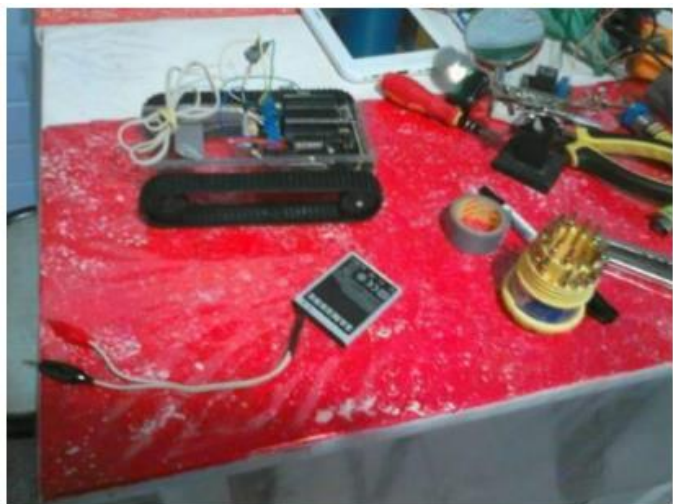
Figura 10 – Chassis de policarbonato expondo fiação e shield de motor com placa Garagino. Ao lado, bateria de celular adaptada para alimentar o protótipo.
