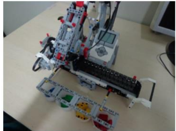
Figura 9 – Parte de ejeção da máquina separadora.
