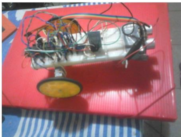
Figura 7 – Robô que alterna deslocamento automático com sensor de distancia e controle pelo celular via Bluetooth
