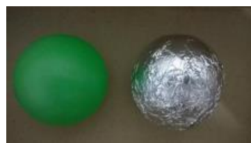
Figura 3 – Exemplos de esferas utilizadas no experimento. Na esquerda há uma esfera normal e na direita uma coberta com papel alumínio.
