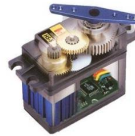
Figura 3 - Servomotor por dentro. Fonte: http://www.pictronics.com.br/artigos-tecnicos/43-eletronica-eautomacao/89-como-funciona-um-servo-motor.html
