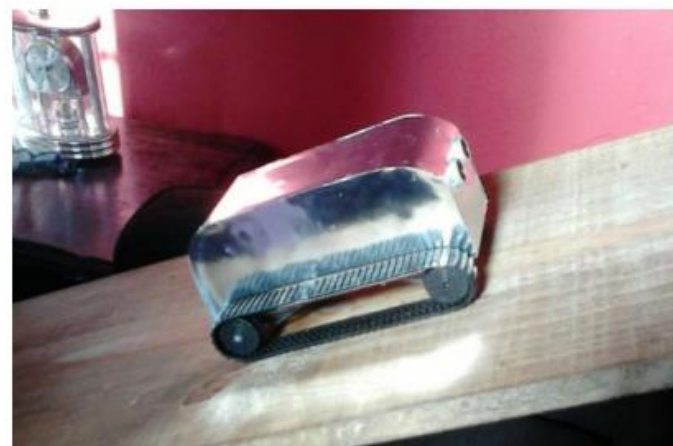
Figura 12 – Teste de escalada em superfície de madeira rústica a 30 graus
