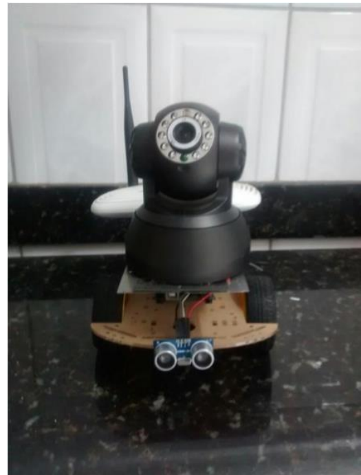
Figura 6 – Parte dianteira do robô onde se encontra o sensor ultrassônico e a câmera IP.
