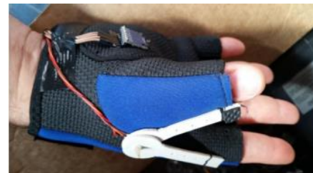
Figura 8 – Luva adaptada com potenciômetro e giroscópio Fonte: Os autores
