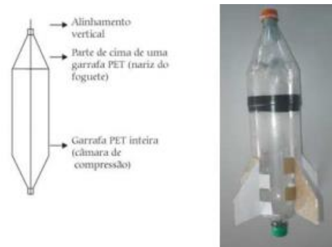
Figura 5 – Definição do foguete (à esquerda) e foguete construído (à direita). Fonte: Souza, 2007 (à esquerda)
