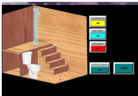
Figura 7 – Controle no Elipse Scada da iluminação, chuveiro e a descarga sanitária.
