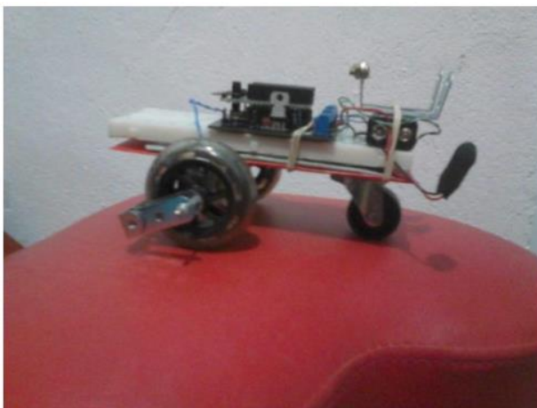
Figura 6 – Robô de tres rodas com pneu de borracha de patins
