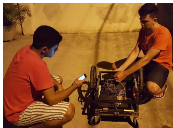
Figura 4 – Instalação dos Motores e Bateria para funcionamento da cadeira
