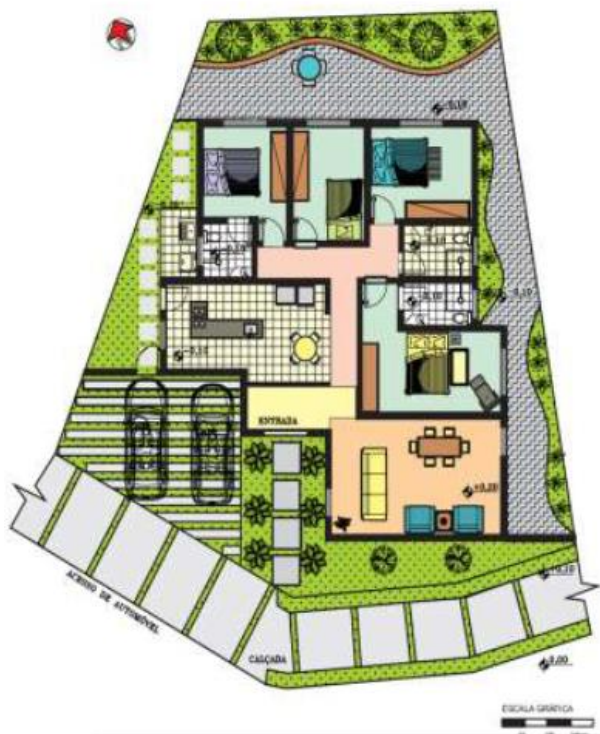
Figure 1 - Planta baixa da edificação proposta.
