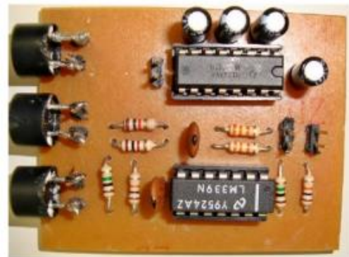
Figure 8 - Placa de Circuito Impresso do Sensor de Ultrassom [Andreoti, 2012]
