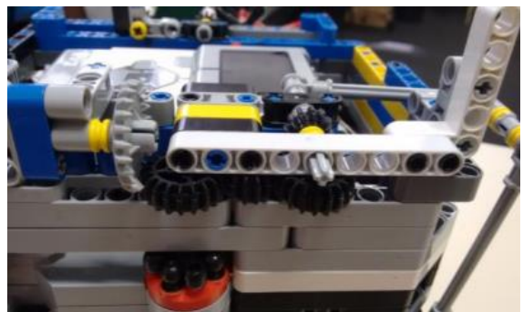
Figura 2 – Transmissão para o anexo com engrenagem manivela.
