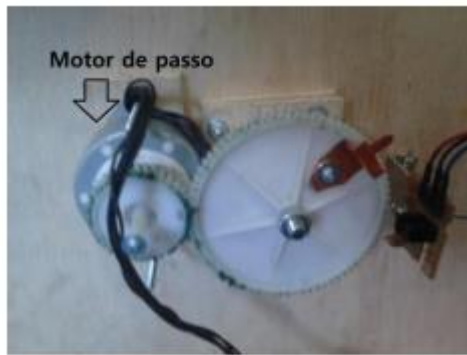
Figura 4 - Mecanismo para fazer o protótipo girar.
