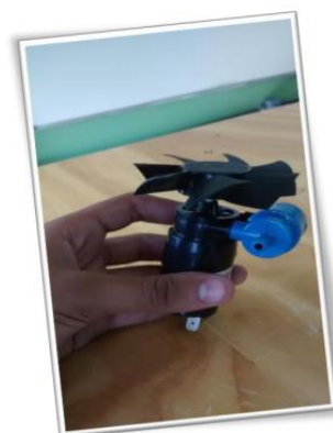
Figura 4 - Motores de bomba reservatório de água de limpador de para brisa
