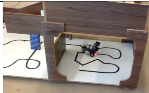
Figura 7 – Robô completando interrupção de linha (“gap”)
