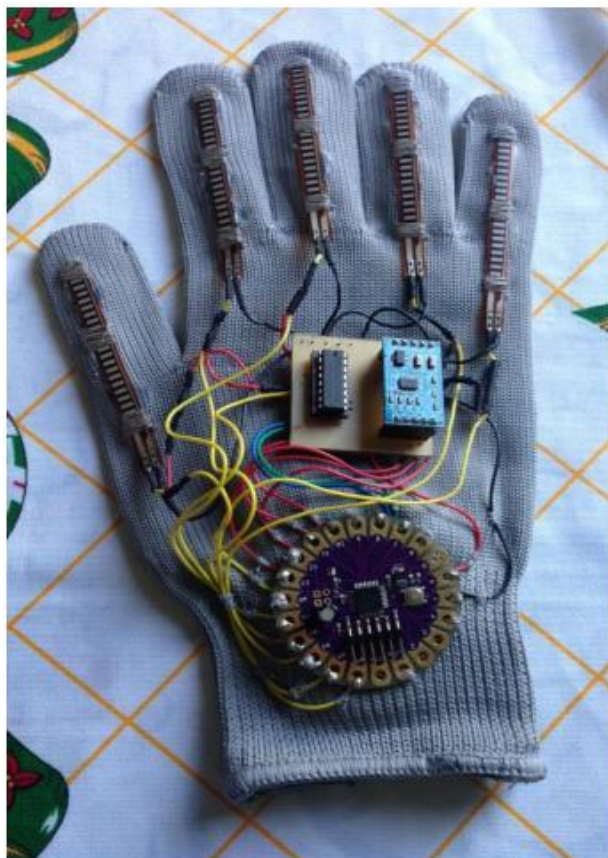
Figura 7 - Luva de resistores flexíveis.
