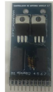
Figura 4: Controlador de Motores.
