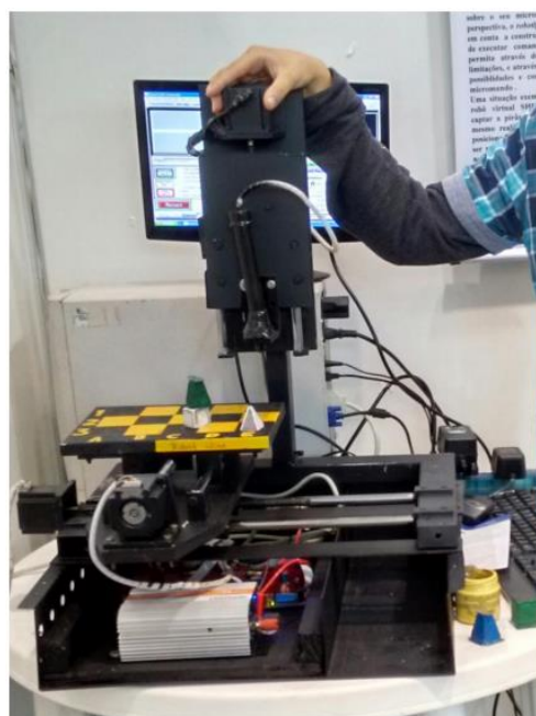
Figura 3- Webcam acoplada ao Robot Wino. Fonte: Imagens do arquivo dos pesquisadores.
