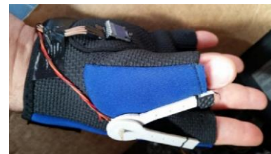
Figura 7 – Luva adaptada com potenciometro e giroscópio Fonte: Os autores (2015)
