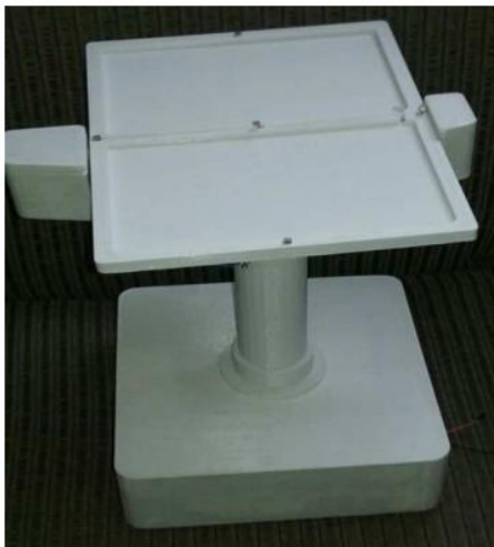
Figura 8 - Estrutura para as placas fotovoltaicas concluída.
