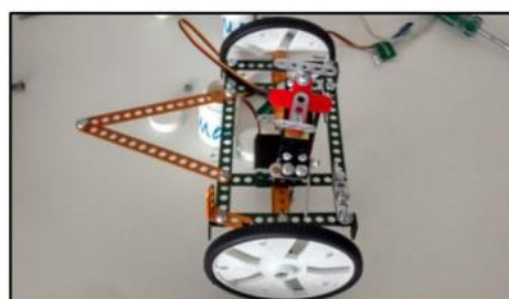
Figura 5 - Parte inferior da caçamba com os servomotores
