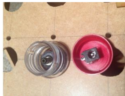
Figura 3: Detalhe dos blocos com conectores elétricos [Acervo pessoal]
