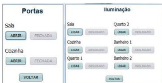
Figura 7 – Tela do gerenciamento das portas (esquerda) e da iluminação (direita).
