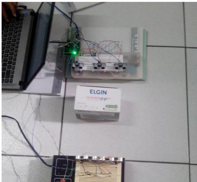
Figura 3 - Teste com seis sensores ultrassônicos.
