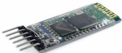
Figura 1 - Módulo Bluetooth® HC-05.
