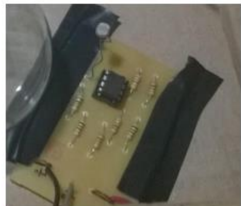
Figura 6 - Circuito medidor de luminosidade
