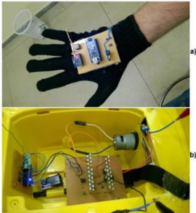
Figure 9 - Circuitos impressos implementados do sistema. Em (a), sistema háptico, e em (b) o circuito receptor acoplado a Ponte H, ligada ao motor (IFBA, 2015).
