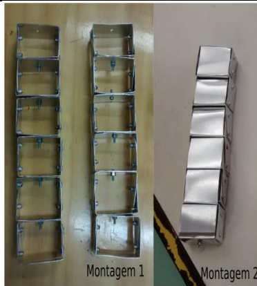
Figura 3 - Estrutura das Pernas.
