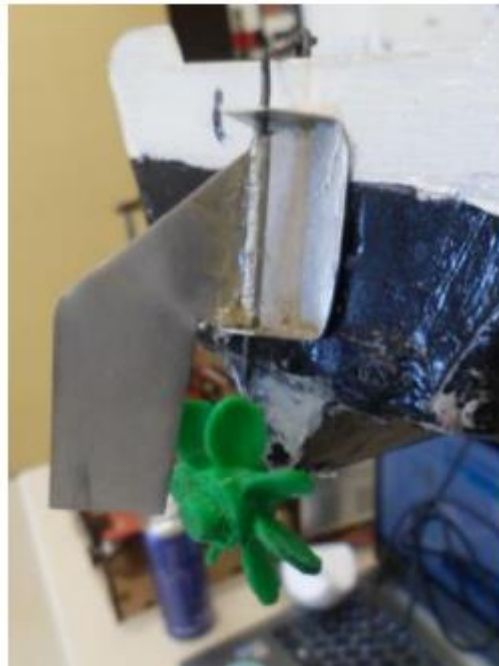
Figura 9 - Leme de alumínio e hélice já em PLA
