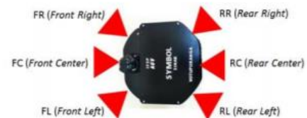
Figura 4: Projeto da integração de sensores de distância no Symbol.
