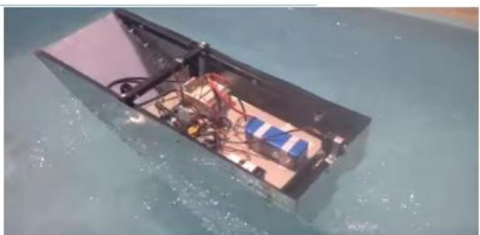
Figura 2 - Barco RC caseiro de metal, com Arduino
