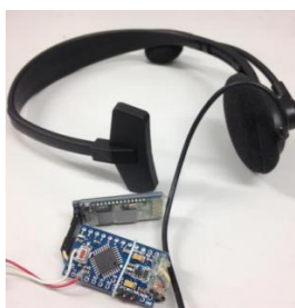
Imagem 1 – Montagem do fone de Ouvido via bluetooth
