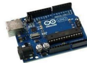
Figura 9 – Plataforma Arduino Uno juntamente do ATMEGA 328.
