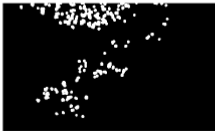
Figura 4 - Resultado do processo de Abertura na imagem da placa. Fonte: Autor, 2016.
