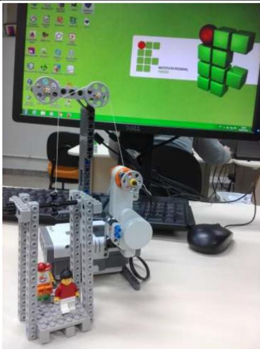
Figura 2 -Elevador robô com a linha e um motor
