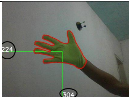
Figura 6 - Ao lado esquerdo pode ser visto a indicação da altura da mão (224), na parte inferior pode ser visto a indicação do deslocamento em relação ao ponto inicial da imagem (304). E ao redor da mão, pode ser visto, em vermelho, o contorno da mão.
