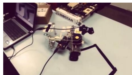
Figura 7 - Robô seguindo linha pela visão computacional em uma plataforma de testes utilizando o notebook como controlador principal.
