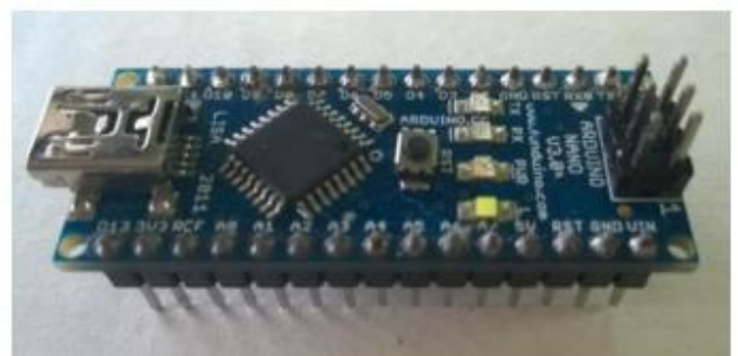
Figure 3 - Sistema embarcado Nano, um dos diversos modelos de Arduino (IFBA, 2015).
