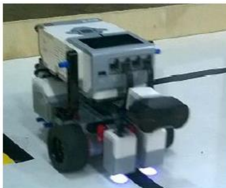
Figura 3 - Estrutura do LEGO Mindstorms® EV3 adotada.
