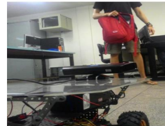
Figura 6 - Robô perseguindo o objeto de acordo com os movimentos do alvo predeterminado em um ambiente controlado.
