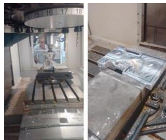
Figura 3 – Usinagem do chassi.
