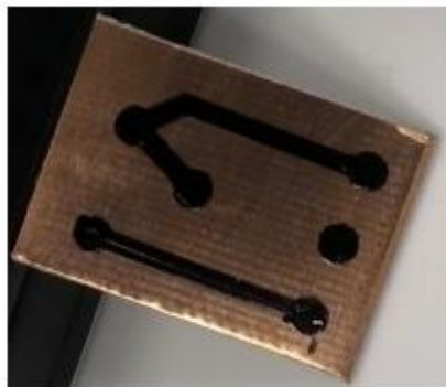
Figura 5 - Placa feita com pincel de tinta permanente na fresadora CNC.
