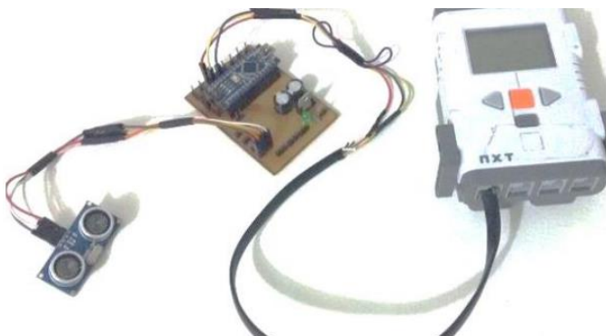
Figura 5. Placa conectada ao NXT com um sensor ultrassônico.
