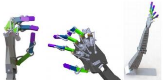
Figura 8 - (a) mecânica dos dedos do braço. (b) e (c) modelagem do braço robótico e adição dos servomotores.
