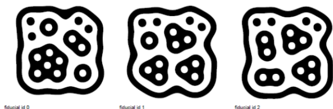
Figura 1- Exemplo dos marcadores fiduciais do tipo “amoeba”. Fonte: Print screen de PDF contido no pacote do ReacTIVision 1.5.1.
