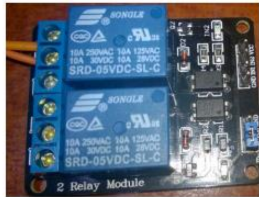
Figura 4 - Módulo com dois optoacopladores
