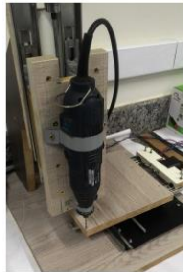
Figura 2 - Montagem do eixo x e y e finalização parcial da estrutura.
