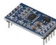
Figura 2 - Acelerômetro selecionado para o trabalho
