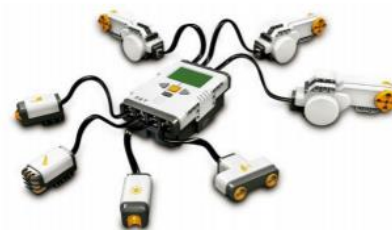
Figura 2.1. Detalhes do kit NXT, apresentando o controlador conectado a seus sensores e motores.
