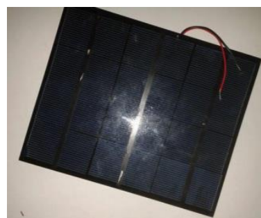
Figura 3 – Placa solar para carregamento da bateria.
