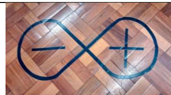
Figura 9 - Pista de testes para o modo seguidor de linha
