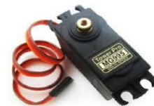
Figura 6 – Micro Servo Tower Pro MG995 Fonte: TORQ (2015)
