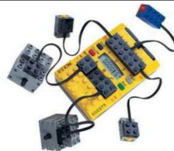
Figura 2. Detalhes do kit RCX, apresentando o controlador conectado a seus sensores e motores.
