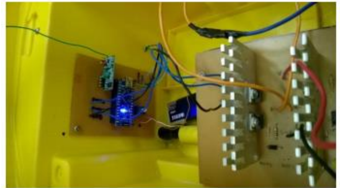
Figure 11 - Placa receptora, já acoplada a Ponte H (IFBA, 2015).
