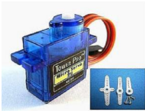
Figura 7: Micro servo 9g TowerPro SG90. Fonte:SERVO DATABASE
