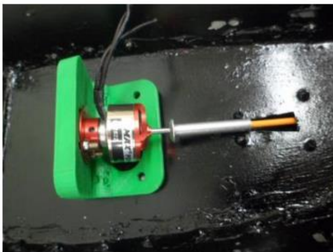
Figura 11 - Motor com o suporte de PLA e eixo que forçava o atrito
