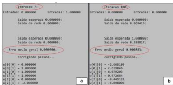
Figura 7 - Processo iterativo de RNA's, em a) utilizando a função degrau e em b) utilizando a função sigmoid.
