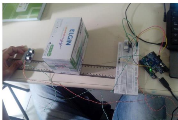
Figura 2 - Teste com dois sensores ultrassônicos.
