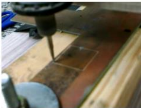
Figura 4 - Quadrado 2cm x 2cm feito na fresadora CNC.
