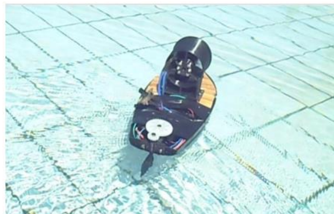
Figura 14 - BarcoINO 2.0 de PLA em um dos testes na água
