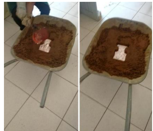
Figura 2 – Fundição do chassi.
