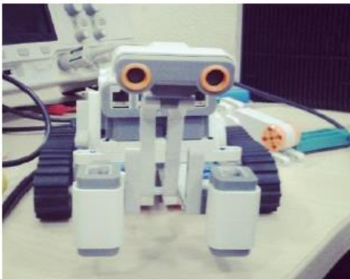
Figura 2 - Estrutura do LEGO Mindstorms® NXT adotada.
