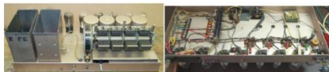
Figura 4. Placas de circuitos, sobre u chassi de chapa metálica.
