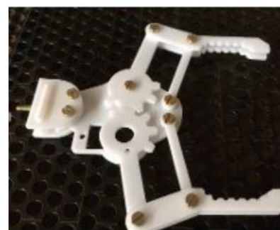
Figura 3 – Garra utilizada para resgate
