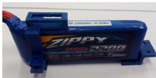
Figura 85 - Bateria com suportes impressos.
