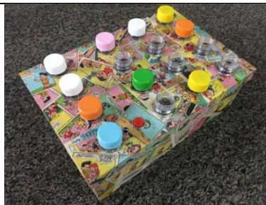
Figura 1 - Sistema completo com blocos, LEDs de indicação e botão de início [Acervo pessoal]
