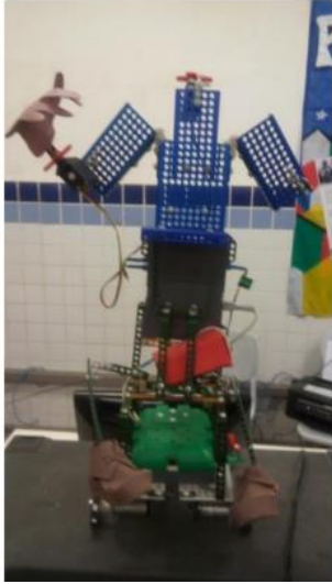
Figura 02 – Estrutura metálica com os servos e rodas
