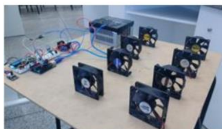
Foto 4: Maquete com acionamento de coolers
