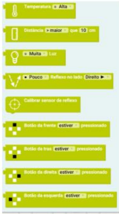
Figura 119 - Blocos dos sensores utilizados
