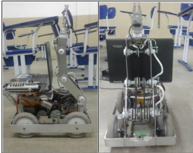
Figure 58 - Robô adaptado para levar o notebook, o NodeMcu e a câmera.
