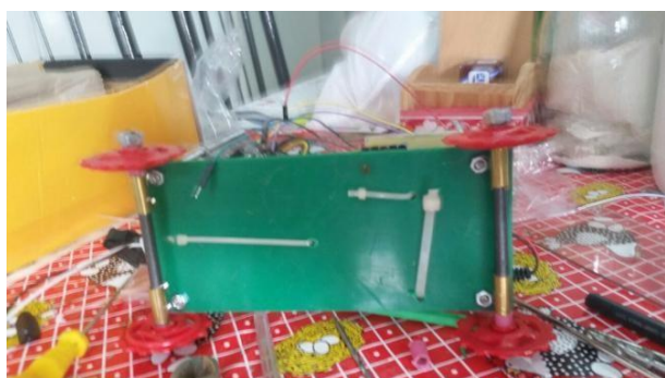
Figura 220 - Parte de baixo do robô demonstrando a fixação dos componentes por meio de abraçadeiras, junto aos respectivos eixos.
