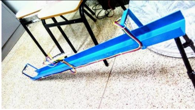
Figura 208 - Rampa já com os sensores já feitas as ligacoes no arduino
