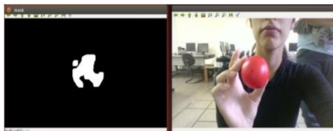
Figura 4 - Demonstração dos efeitos da luz no objeto de cor vermelha em ambiente claro.
