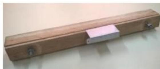
Figura 5 - ferramenta concebida e construída para dobramento de peças planificadas.
