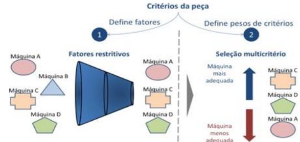
Figura 144 - Lógica da seleção do processo de prototipagem rápida na indústria 4.0. Fonte: Kolberg e Zühlke (2015).
