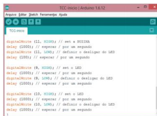
Figura 9. Programação, informando as Leds e buzina, com suas definições, ligado e desligado.
