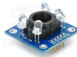
Figura 7. Módulo sensor de reconhecimento de cor - Tcs3200
