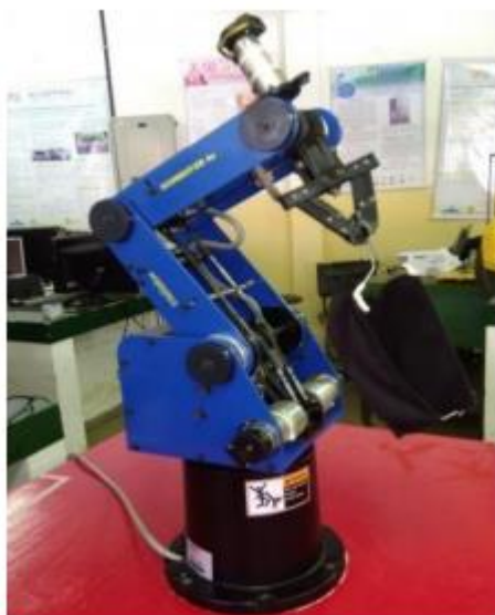
Figure 41 - Manipulador robótico Scorbot er 4u.
