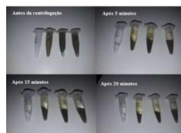
Figura 2. Tubos de centrífugas com as respectivas amostras antes e depois de serem centrifugadas.
