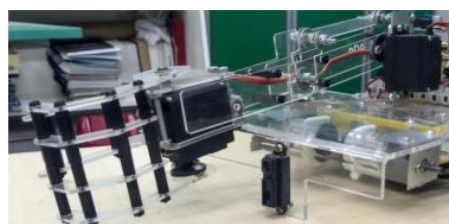
Figura 2 - Versão final do braço robótico, abaixado.
