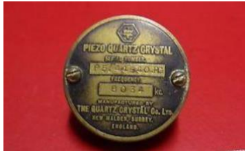
Figura 4 – Cristal de quartzo utilizado em rádios militares (Fonte: Hereford, Mike. 2017)
