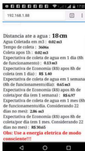
Figura 3 - dados após 1 hora, referentes a vasão de água do ar condicionado da marca Rheem.
