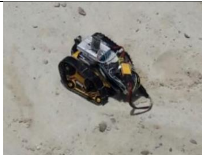
Figura 3 - Robô sendo testado em solo arenoso
