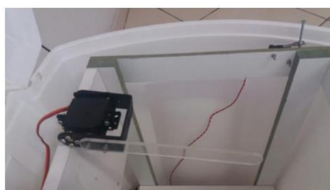
Figura 8 – mecanismo para abertura da tampa.
