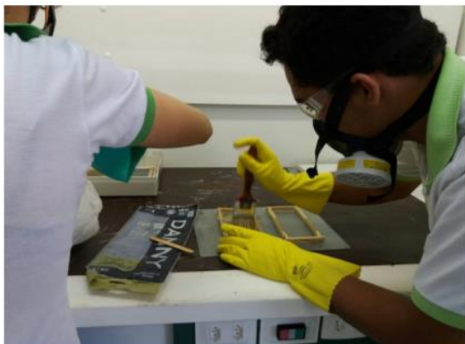
Figura 5 - Fabricação do PRFV utilizando a técnica de laminação manual.
