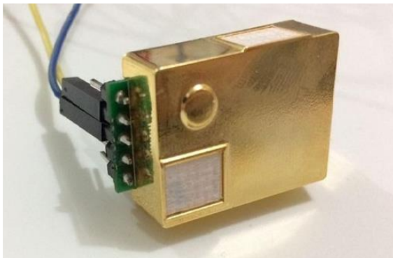
Figura 252 - Sensor Mhz-19 para medição do CO2.
