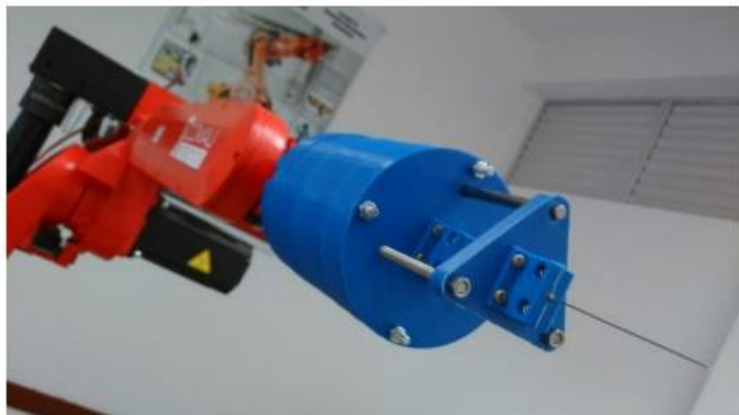
Figure 79 - Ferramenta montada e acoplada ao flange do robô.
