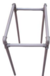
Figura 3 - Plataforma de suporte ao posicionamento vertical de protótipos do robô para estudos de movimentos articulares.
