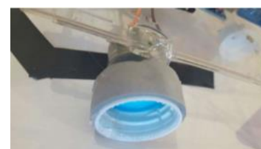
Figura 5 – Rodas dos robôs utilizando motores DC de leitor de DVDs quebrados conectados a rodas feitas de tampinha de garrafa pet.
