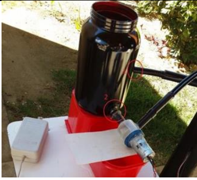
Figura 138 - Reservatório de água ligado à bomba hidráulica
