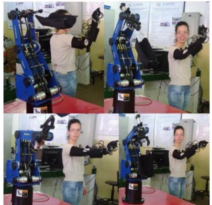
Figure 47 - Movimentação do robô em sincronia com a luva háptica.
