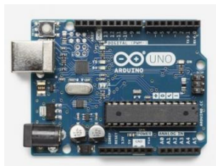
Figura 2 - Arduino UNO [2] codificada em linguagem C
