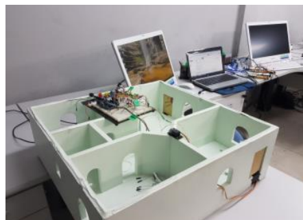
Figura 5 - Protótipo de Smart House.
