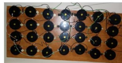
Figura 11 - Protótipo de testes composto por 28 buzzers [Do próprio autor]
