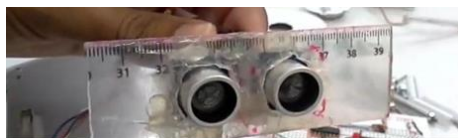
Figura 238 - Montagem da sustentação dos sensores ultrassônicos.
