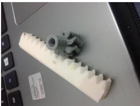
Figura 155 - Cremalheira com Dentes do tipo Herring Bone
