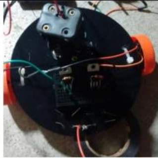
Figura 4 – Robô TIP 122 estrutura em DVD
