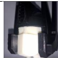
Figura 4 - Cabeça do COBRA construída por impressão 3D.
