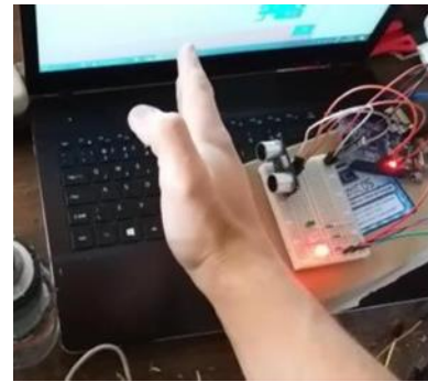
Figura 140 - Aproximação ao sensor ultrassônico e acionamento do led vermelho
