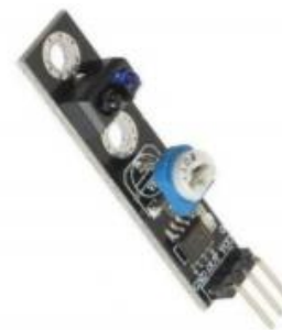
Figura 6. Módulo sensor de seguidor de faixa
