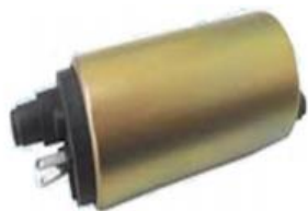
Figura 7: Refil de bomba de combustível. Fonte: Autor (2017)
