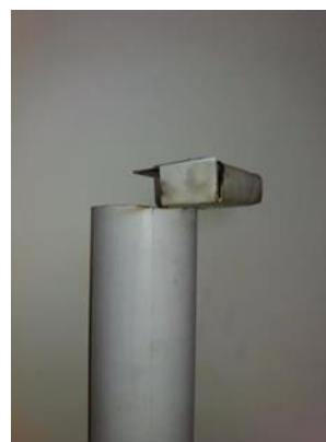
Figura 137 - Capa de proteção do sensor finalizada
