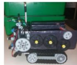
Figura 18 – Detalhe das engrenagens que movimentam a basculante
