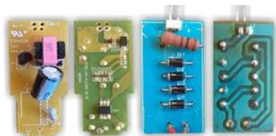
Figura 66 - Driver da lâmpada original(esquerda) e o modificado(direita).
