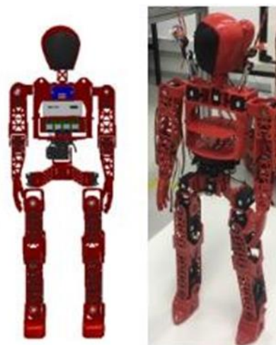
Figura 101 - MartaBot. Esq. Desenho desenvolvido; Dir. primeiro protótipo impresso e montado.
