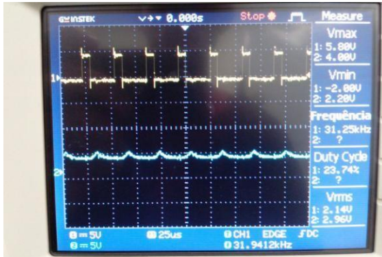
Figura 131 - Sinal do PWM e saída do conversor Buck (IFBA, 2017)
