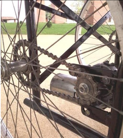
Figura 104 - Estrutura com transmissão flexível desenvolvida.
