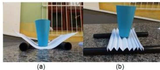
Figura 135 - Experimento com o papel liso (a) e papel ondulado (b).
