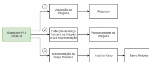
Figura 4 - Representação hierárquica dos procedimentos realizados para manipular o braço robótico.
