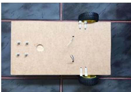
Figura 131 - Chassi do carrinho já com fios conectados aos motores.
