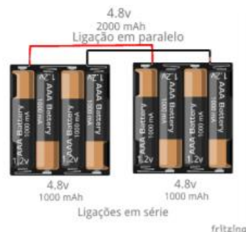
Figura 8 - Diagrama de ligação dos bancos de baterias.
