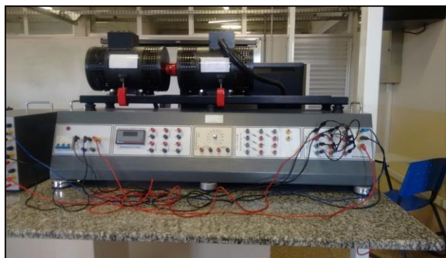
Figura 188 - Bancada de Acionamento de Máquinas Elétricas.
