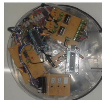
Figura 3: Placas de acionamento dos atuadores e sensores do robô.
