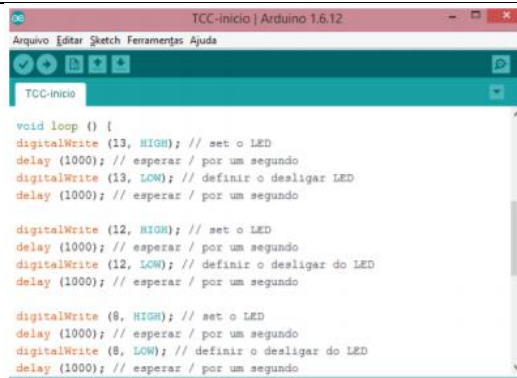
Figura 8. Programação, informando as Leds, com suas definições, ligado e desligado.
