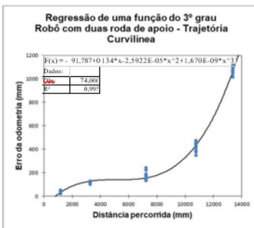
Figura 182 - Regressão de uma função do 3º grau - Trajetória curvilínea. Fonte: Elaborado pelo autor.
