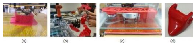
Figura 100 - Etapas do processo de produção do robô: a) impressão; b) ajuste; c) aplicação de vapor de acetona; d) resultado final.
