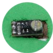
Figura 269 - Sensor de reflectância para detecção da passagem do trem.
