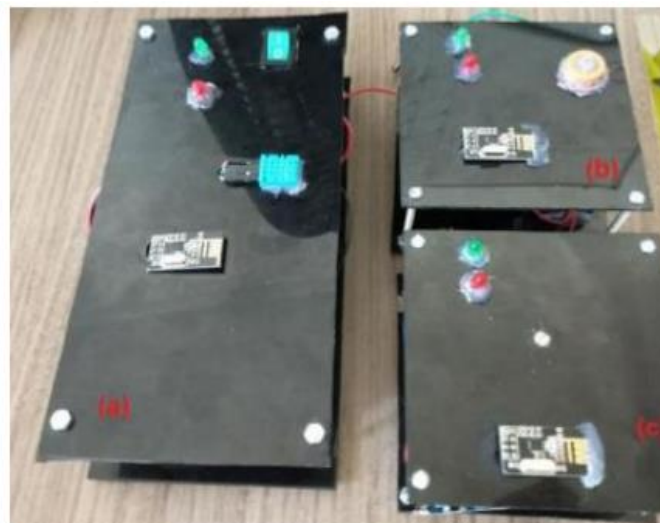
Figure 13 - Fotografia dos módulos de sensoriamento. (a) Módulo de Umidade e Temperatura com o sensor DHT11; (b) Módulo de gás e etanol com o sensor MQ-3; (c) Módulo de luminosidade com o LDR.
