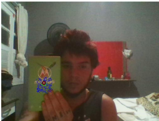
Figura 6 – Saída do filtro de partículas, contendo a estimativa do centro de massa do objeto alvo representada por um ícone circular vermelho, preto e branco.
