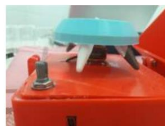
Figura 1. Carrossel da centrífuga utilizada na separação com as respectivas amostras.
