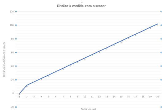
Figura 188 - Gráfico de erro de dimensões do sensor ultrassônico
