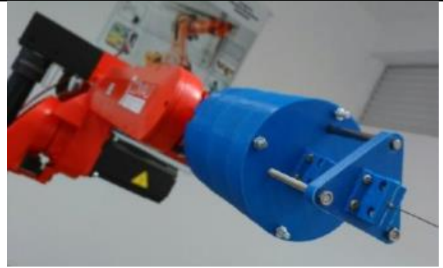
Figura 606 - Ferramenta [2] acoplada à flange do robô
