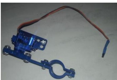
Figura 378 - Garra feita na impressora 3D.
