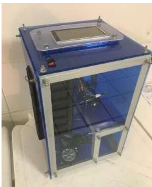
Figura 530 - Visão externa e interna do projeto. (Tablet superior juntamente com interruptores, gavetas frontais, acrílico na lateral com visão de montagem interior.
