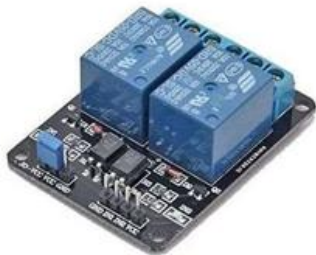
Figura 347 - Módulo relé com 2 canais
