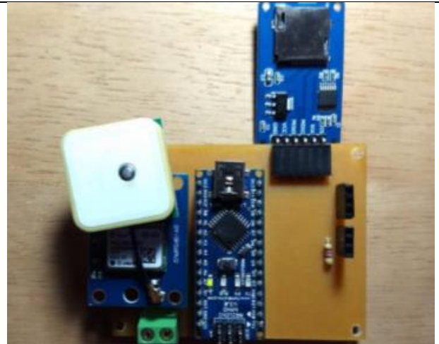
Figura 9 - Placa de circuito para data logger.
