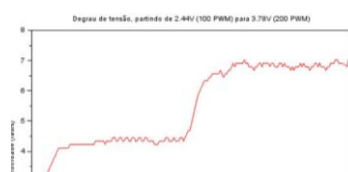
Figura 4 - Degrau de tensão aplicado ao sistema O valor da constante L encontrado nesse processo foi de 0.160 (segundos)
