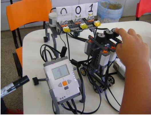
Figura 26 - Robô que executa a conversão binário-decimal.
