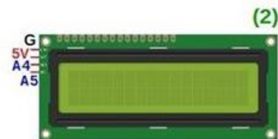
Figura 62 - Esquema de ligação do LCD com módulo I2c.
