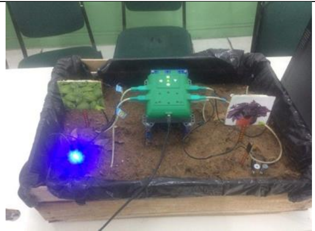
Figura 463 - Protótipo do sistema de controle de temperatura, umidade e luminosidade.
