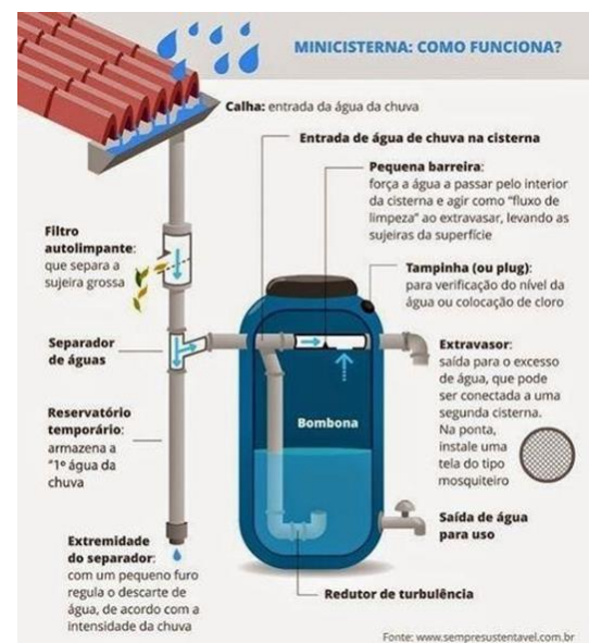
Figura 39 - Funcionamento Mini cisterna. Fonte: www.sempreresistentavel.com.br
