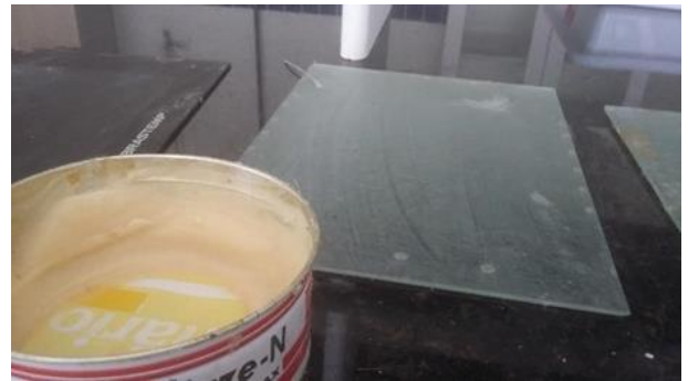
Figura 342 - Aplicação de desmoldante.
