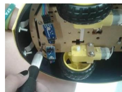
Figura 21 - Encaixe do chassi nas abraçadeiras – Fonte: Autor
