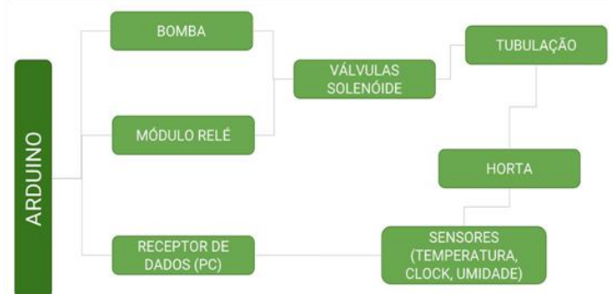
Figura 178 - Fluxograma com a ordem de montagem do protótipo
