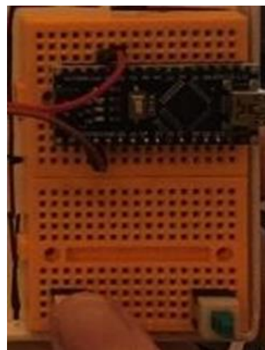
Figura 521 - Botões inferiores para aumentar/diminuir a frequência de rádio
