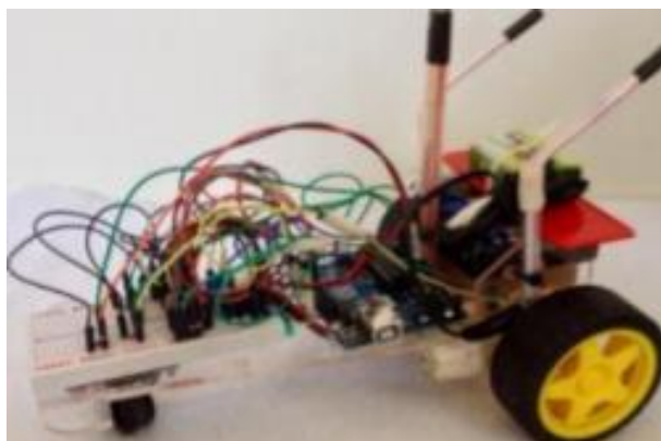
Figura 587 - Robô controlado por sensores de luminosidade
