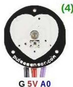
Figura 63 - Esquema de ligação do monitor de pulso.
