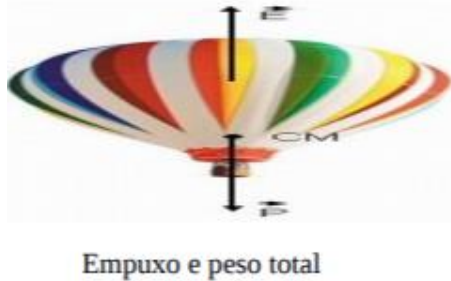
Figura 657 - Esquema mostrando o empuxo e o peso total do balão
