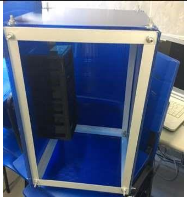
Figura 527 - Modelo estrutural do robô sintetizado com hastes e policarbonato.
