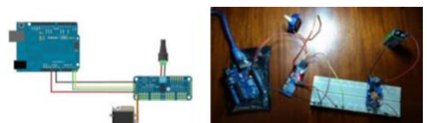
Figura 578 - Conexões e teste do Driver PWM, Arduino Uno e Servo motor
