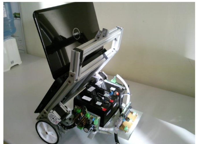
Figura 12: Visão do OpenVisionBot completo (webcam integrada ao notebook)
