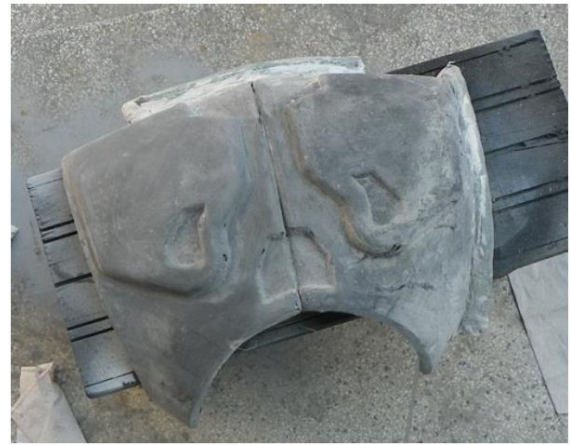
Figura 7 - Processo de produção das costas do robô em fibra de vidro.
