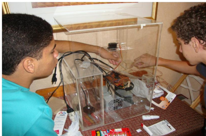
Figura 4: Imagem que representa o momento de construção da mecânica do robô comunicador. É possível se observar o controlador, os atuadores e os sensores.
