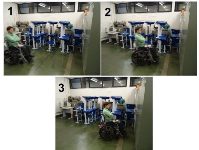
Figura 2 - Reação da cadeira de rodas ao encontro de um obstáculo.
