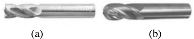
Figura 5 - Fresas utilizadas no processo de estudo da produção do molde. a) fresa de topo reto; b) fresa esférica tipo “ballnose”, com melhor acabamento para usinagens 3D.
