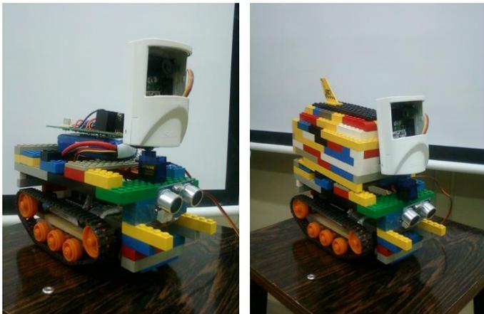
(a) Plataforma de apoio à bateria e circuitos utilizando peças LEGO (b) Estrutura final do protótipo
