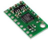
Figura 15 - Acelerômetro e Bússola [13]
