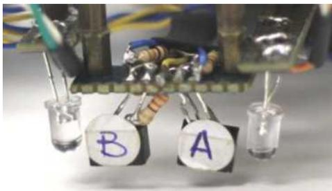
Figura 2 - Sensores por reflexão de luz.
