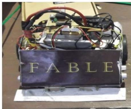
Figura 8 – Protótipo de um Robô Móvel para Participação na Guerra de Robôs na Categoria Sumô Autônomo.
