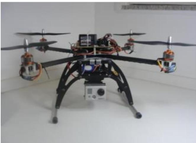
Figura 8 – Câmera montada no quadricóptero.
