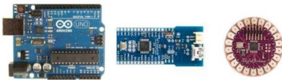
Figura 3 - Arduino Uno, Arduino Fio e Arduino LilyPad.
