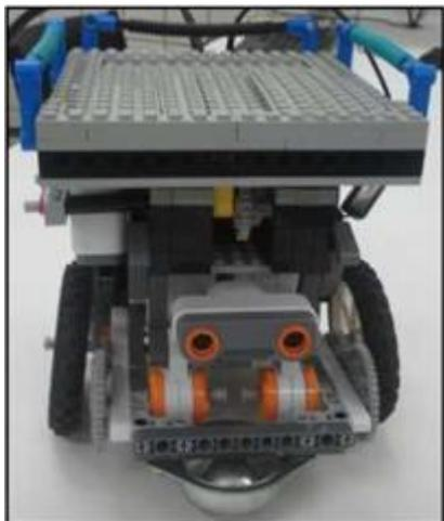
Figura 9. Detector de Estacionamento (fundo do robô).
