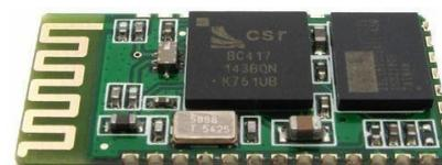
Figura 8 - Módulo Bluetooth serial RS232.
