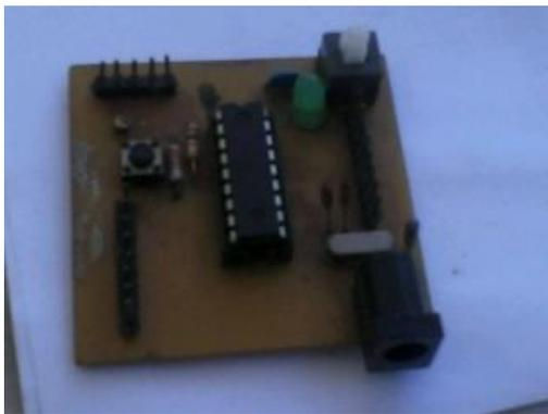
**Figura 7 – Placa do Microcontrolador.**
