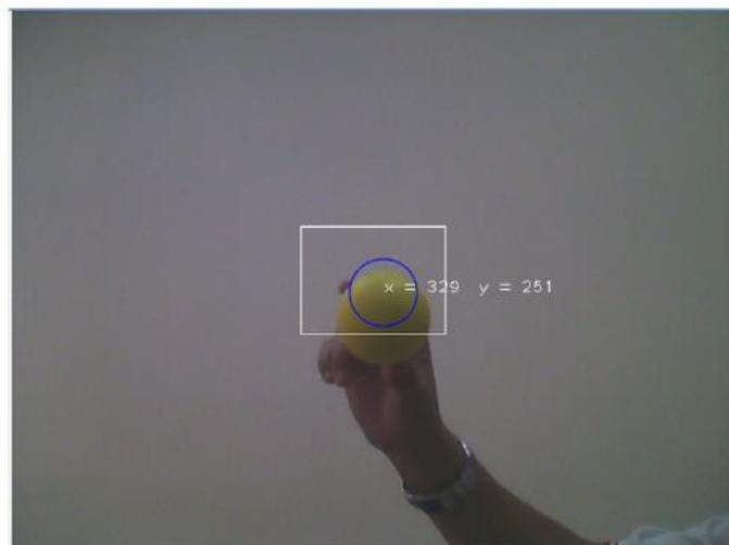
**Figura 4 – Execução do software de detecção de círculo.**
