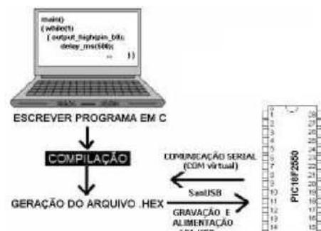
Figura 9 - Ilustração da gravação do microcontrolador PIC18F2550 via USB através do software aplicativo SanUSB.
