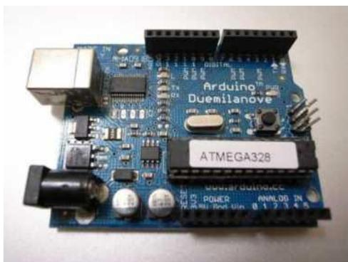
Figura 1 - Controlador Arduino.
