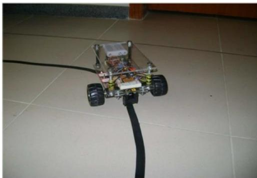
**Figura 3. Robô seguidor de linha.**
