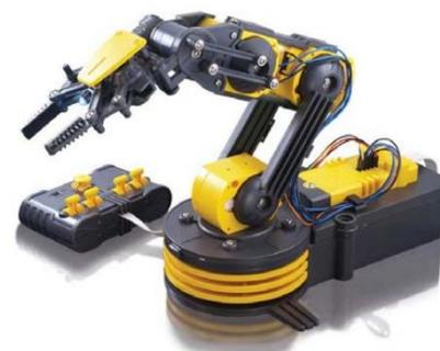
Figura 1- Robô Manipulador Owi-535.
