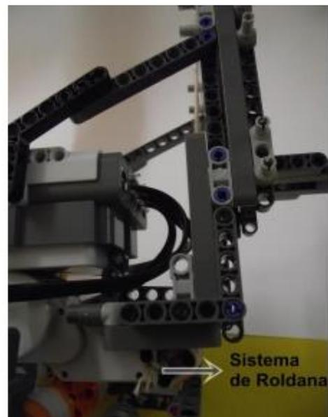
**Figura 5. Sistema de roldana:** permite alterar a direção e o sentido de forças aplicadas em cordas quando estão fixas. Com a ajuda do motor pode realizar suas funções.
