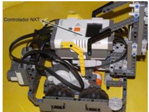
**Figura 4. Controlador do NXT:** Como se fosse a memória do robô, onde é armazenado as programações que são executadas.
