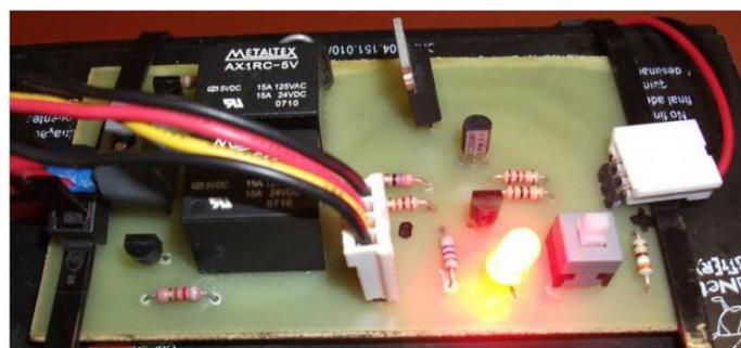
**Figura 10 – Ponte-H do módulo atuador.**
