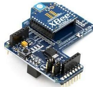
Figura 3 - Shield de Xbee Pro Usado como Base Transceptor dos Comandos.
