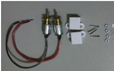
Figura 8 – Motores para tração do robô.
