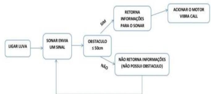
Figura 6 - Diagrama de funcionamento Lógico da Luva Digital Eye.
