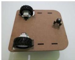
Figura 3: Parte inferior do robô
