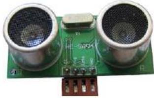
Figura 2. Sensor Ultrassônico – HC-SR04
