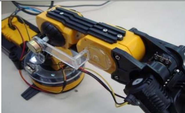
Figura 2 - Detalhe do potenciômetro em cada eixo.
