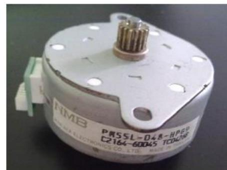
Figura 6. Motor de passo.
