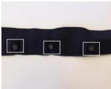
Fig. 7 – Sensores adaptados ao elástico.
