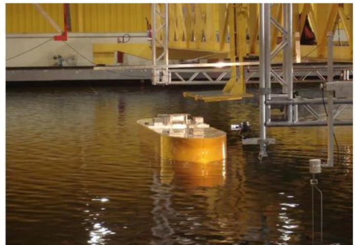
**Figura 1.** -Modelo em escala de navio sendo testado no tanque oceânico do Laboratório de Tecnologia Oceânica da COPPE/UFRJ (retirado da web page do laboratório)
