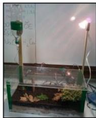
Figura 7. Sistema de Irrigação - Protótipo (versão 1.5).
