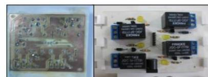
Figura 4: Imagens superiores e inferiores da placa de controle de Relês.
