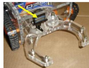
Figura 17 - Garra Robótica acionada por Servo Motor
