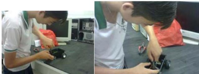
Figura 1 - Fixando motor cc.
