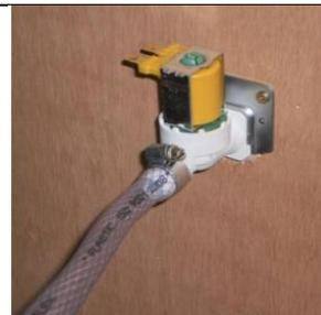
Figura 3: Solenóide conectada a mangueira de água.
