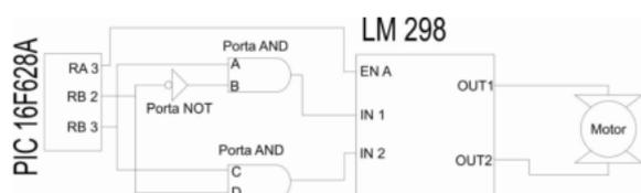
Figura 7 - Esquema básico da unidade de controle dos motores (Esquema por: Rodolfo Alves)
