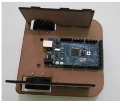
Figura 4: Microcontrolador Arduino Mega.
