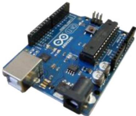
Figura 3 – Arduino modelo UNO
