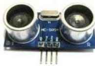
Figura 14 - Sensor Ultrassônico [12]
