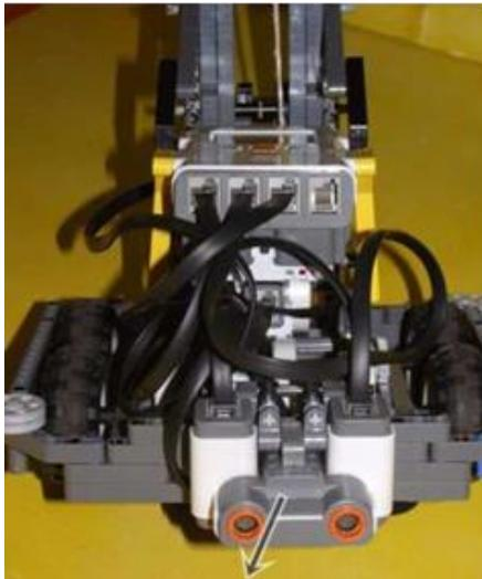
**Figura 2. Sensor Ultrassônico:** Detecta qualquer tipo de objeto em sua frente desviando-o ou realizando alguma ação.
