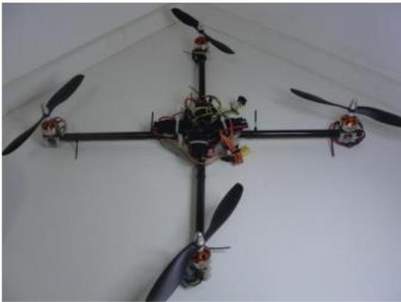
Figura 3 - Estrutura física montada com Fibra de Carbono e Fibra de Vidro.
