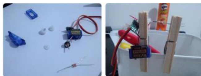
Figura 5 – Processo de modificação dos servos.
