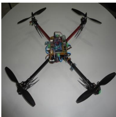
Figura 3 - Protótipo VANT do tipo Quadricóptero. Fonte: Próprio Autor.
