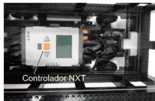
Figura 2 - Controlador NXT é utilizado para armazenar todas as programações e executá-las.
