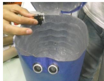
Figura 3 - Adaptando os sensores sonares e servomotores.
