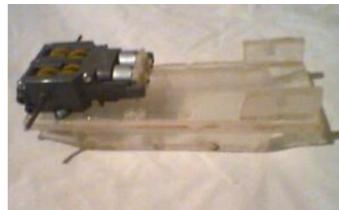
Figura 6 - Esteira na base acrílica.
