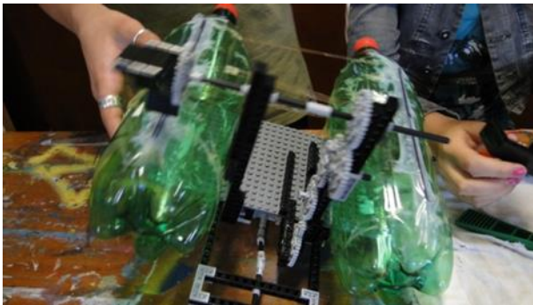
Figura 1- Visualização das engrenagens ligadas em série.
