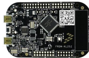
Figura 08 - Microcontrolador FRDM – KL25Z. Fonte: mbed.org.
