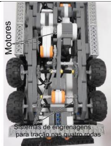
Figura 6 - Sistema de engrenagens empregado para tração das quatro rodas traseiras e motor responsável pela movimentação do ônibus.
