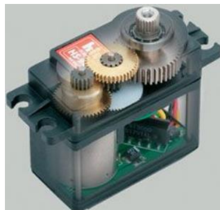
Figura 5 - Servomotor por dentro.
