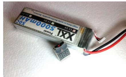
Figura 5 - Bateria 5000mha LIPO e alerta sonoro de bateria fraca.
