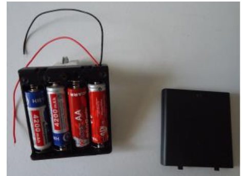
Figura 7 – Segunda etapa da montagem do projeto – colocação de pilhas.
