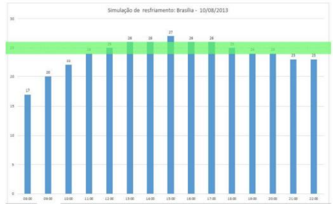
Figura 3 – Gráfico feito a partir de dados retirados do site http://www.timeanddate.com , resfriamento inicia acima da área verde.
