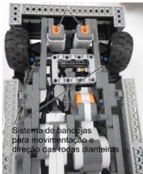
Figura 5 - Sistema de bandejas para movimentação e direção das rodas dianteiras.
