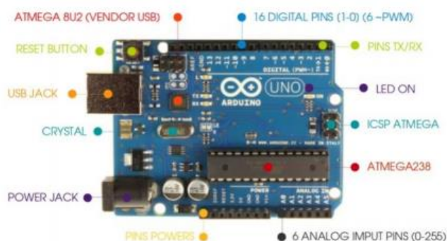
Figura 4 – Arduino UNO Rev. 3 e seus componentes.
