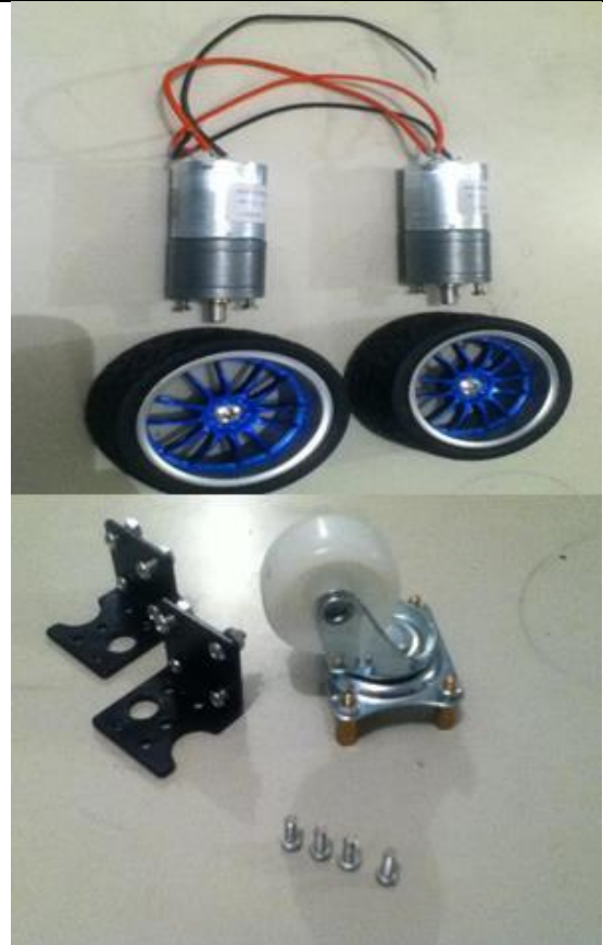
Figura 2- (a) Motores acompanhados das rodas, (b) Roda “boba”, espaçadores e apoios.
