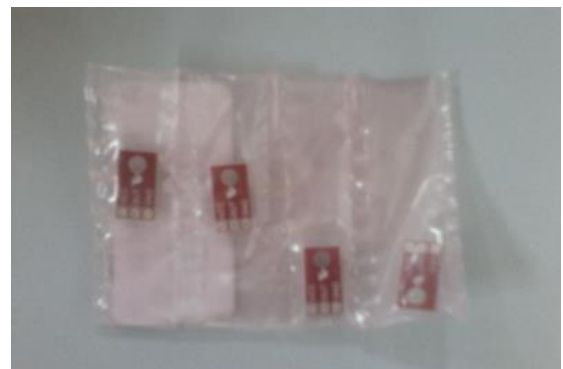
Figura 5 - Sensores de contraste.
