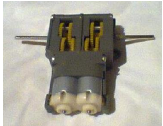
Figura 4 - Caixa de redução dos motores.
