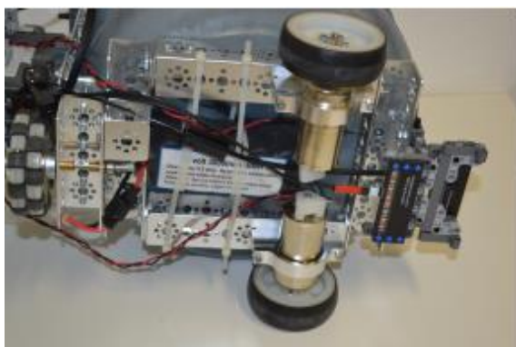
Figura 3- Estrutura de Deslocamento (parte inferior do robô).
