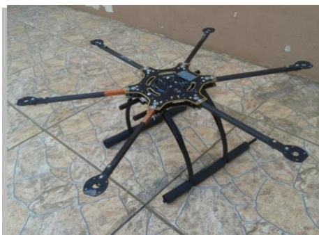
Figura 1- Frame com braços para instalação dos motores e pernas.
