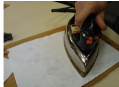
Figura 6 – Transferência do layout da folha para a placa virgem.
