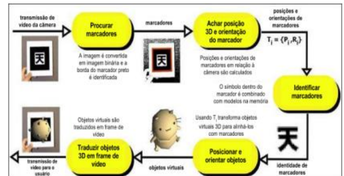
Figura 13. Esquema de funcionamento do ARToolKit
