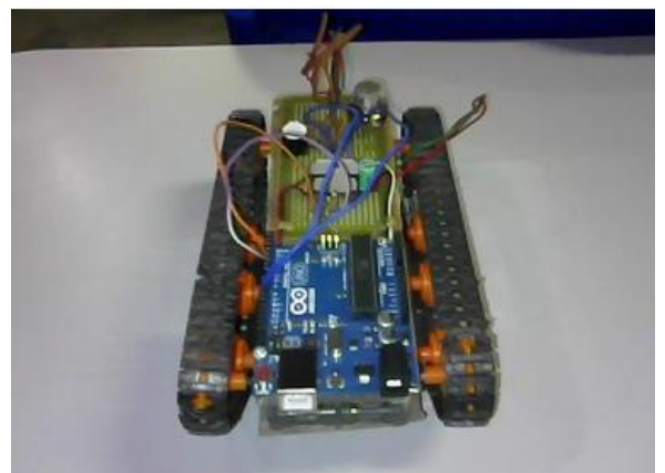
Figura 18 - Com Arduíno e ponte h e sensores.
