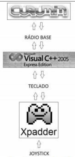
Figura 5. Esquemática da trajetória das mensagens e comandos entre o joystick e o robô Curumim.
