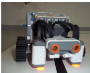
Figura 2. Kit educacional de robô programável LEGO Mindstorms NXT modelo 9797.
