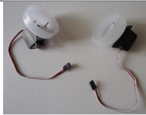
Figura 6 – Primeira etapa da montagem do projeto – servo motores e rodas.
