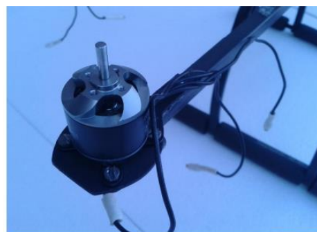
Figura 6 - Motor instalado no braço do frame.
