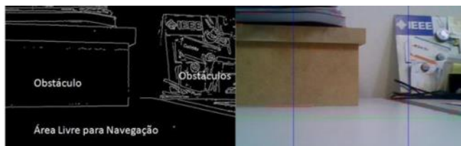
Figura 3 - Detecção de bordas visando identificar a área livre para navegação e o limite dos obstáculos a serem evitados (Fonte:Matheus Doretto Compri [16] - LRMICMC/USP)
