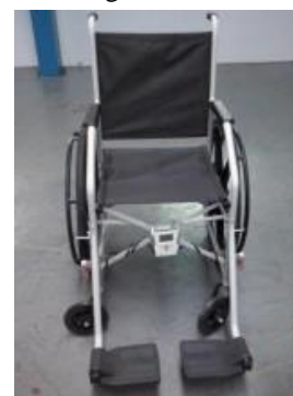
Figura 2 - Robô Lego Zoom acoplado a cadeira com sensores ultrassônicos imóvel.
