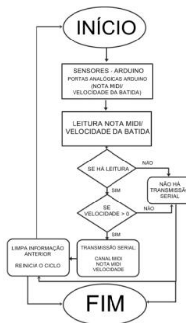
Figura 06: Fluxograma que demonstra como o módulo Arduino processa os sinais
