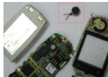
Figura 3 - Motor de Vibração retirado do celular.
