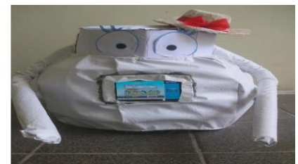
Figura 10 – Estrutura do robô Figura 11- Protótipo do robô coberto com tecido Corine (antibacteriano e feito de arame antialérgico) e com uma identidade própria que chame a atenção das crianças com sua tela interativa.
