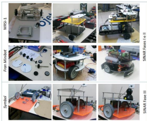
Figura 1 - Mosaico de imagens de estágios da construção das Plataformas Robóticas do SINAR.
