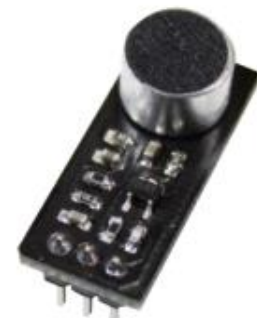
Figura 6 – Microfone de eletreto utilizado no projeto.
