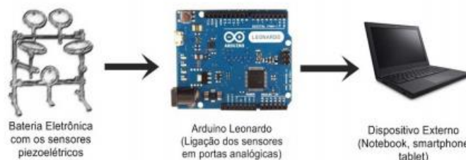
Figura 07: Esquema simples de ligações entre os componentes principais do protótipo.
