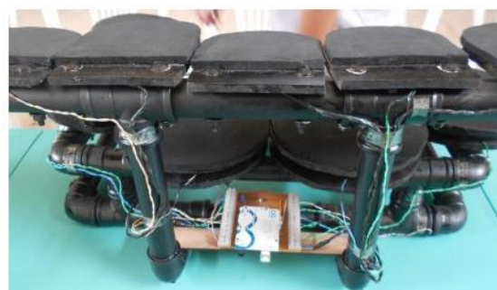
Figura 04: Visão frontal da modificação da estrutura para a adição de mais pads
