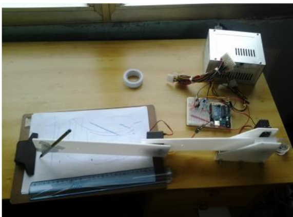
Figura 18 - Robô Pintor em seu primeiro teste real
