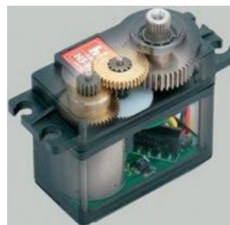
Figura 2 – Servomotor por dentro. Fonte: http://www.pictronics.com.br/artigos-tecnicos/43-eletronica-automacao/89-como-funciona-um-servo-motor.html
