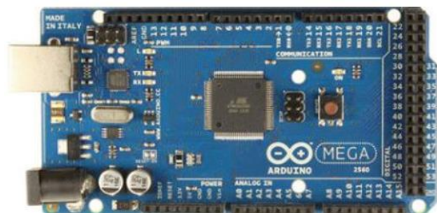
Figura 1 - Placa Arduino Mega 2560 Frente R3. Disponível em: < http://multilogica-shop.com/arduino-mega2560 > Acesso em: 11/10/2013
