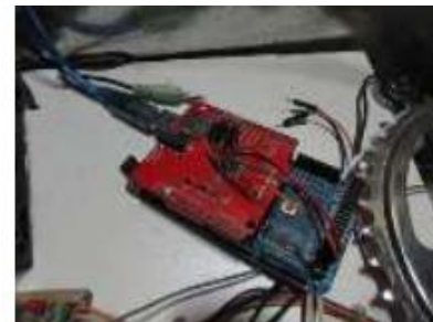
Figura 6 - Arduino responsável pelo controle de áudio.
