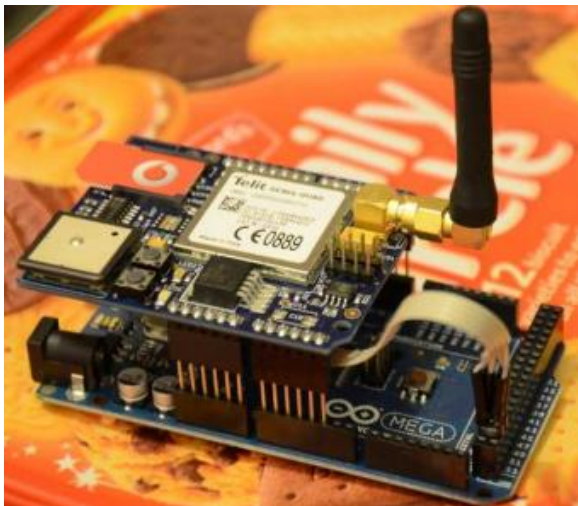
Figura 2 – Plataforma Arduino e shield GPS-GSM acoplado
