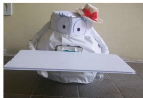
Figura 12 – Protótipo do robô coberto com tecido Corine (antibacteriano e antialérgico) e com uma identidade própria que chame a atenção das crianças.
