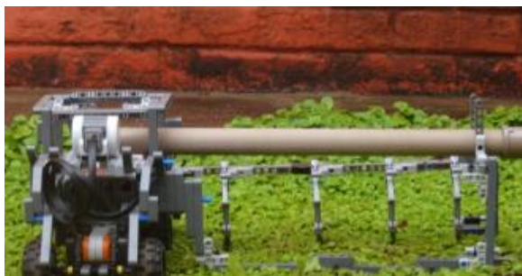
Figura 4 - Extensor para cobertura das "covas" abertas
