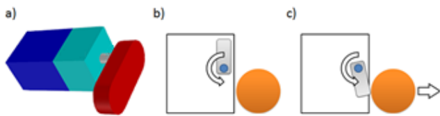
Figura 5 – Desenho CAD e funcionamento do mecanismo de chute.
