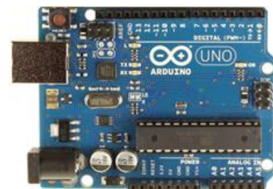
Figura 192 - Arduino UNO R3
