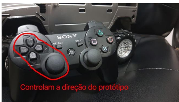
Figura 13 - Gamepad do Playstation 3 utilizado para controlar o Raspcar.
