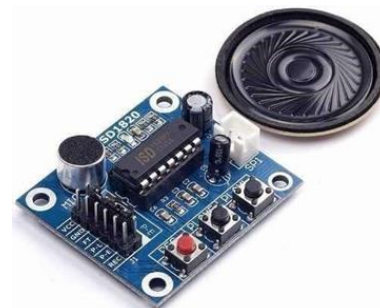
Figura 372 - Módulo de Gravação de Voz é base no ISD1820
