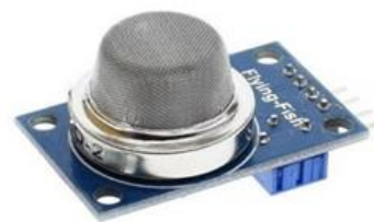
Figura 475 - Sensor de gás MQ2
