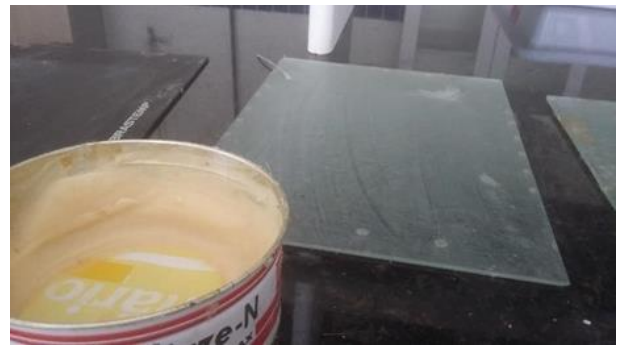
Figura 342 - Aplicação de desmoldante.
