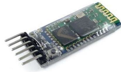
Figura 20 - Módulo Bluetooth HC-05
