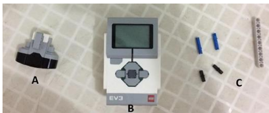
Figura 384 - A. Sensor de infravermelho. B. Central de comando. C. Peças de encaixe.
