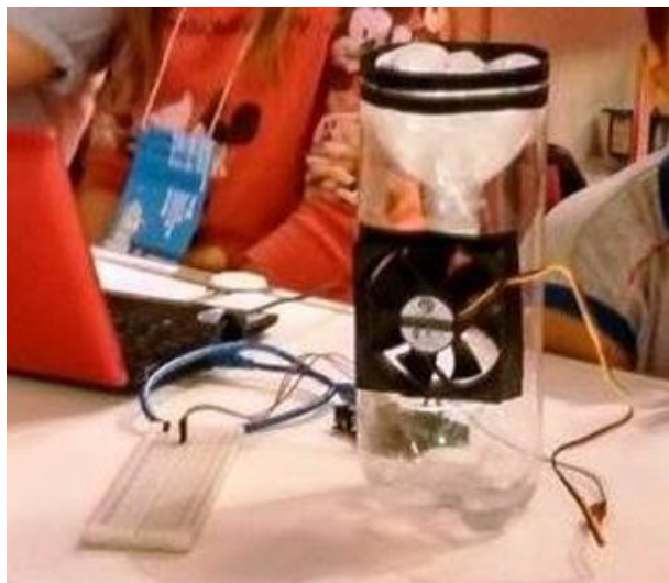
Figura 11 - Ar condicionado sustentável – Arduino Uno – Fonte: Autor
