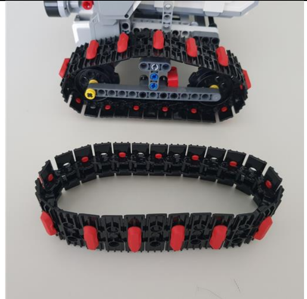
Figura 300 - Esteira com Travas de Borracha.
