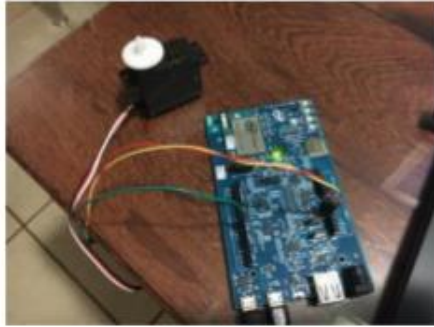
Figura 579 - Programa e teste do servomotor com a placa Intel Edison
