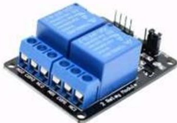
Figura 232 - Módulo Relé 2 Canais
