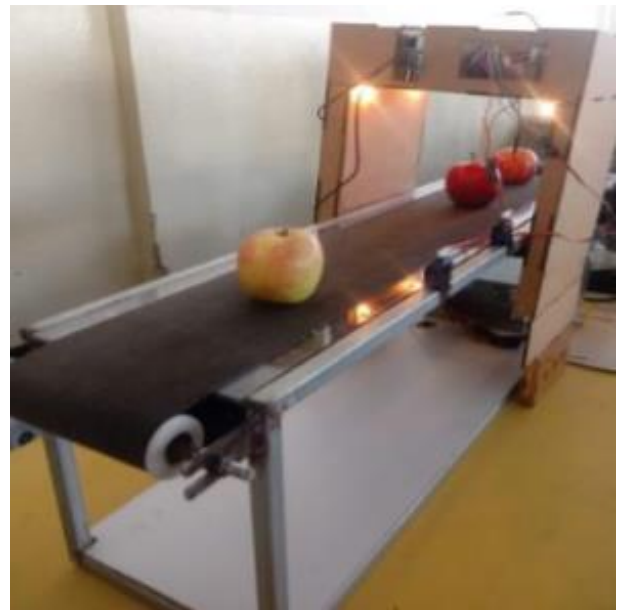
Figura 698 - Estrutura da Esteira para Seleção de Frutas.
