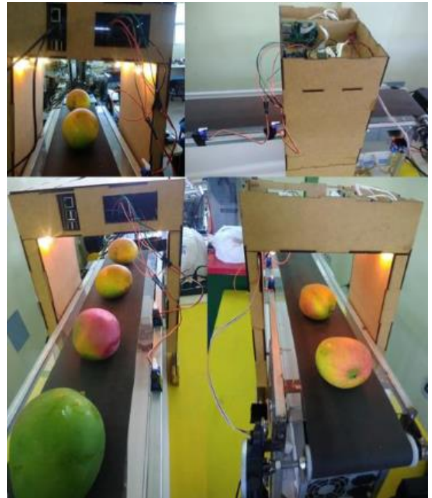
Figura 705 - Sistema de classificação inteligente de mangas.
