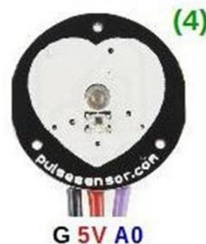
Figura 63 - Esquema de ligação do monitor de pulso.
