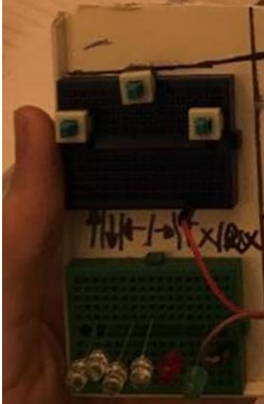
Figura 522 - Botões superiores para controle de movimento (esquerda/direita/ frente) e LEDs correspondentes
