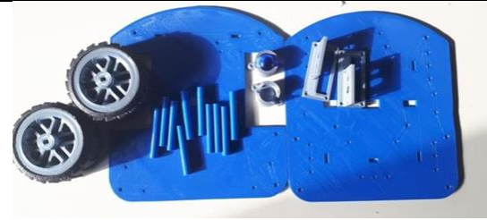
Figura 9 - Peças 3D que compõem o robô
