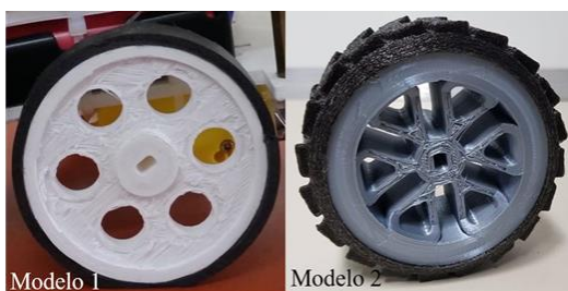
Figura 8 - Comparação das versões inicial e final das rodas
