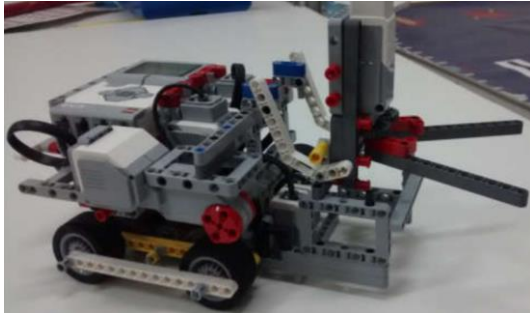
Figura 7 - Garra abre-fecha que serve para empurrar as bolinhas na “corrente sanguínea”.
