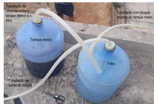
Figura 3 - Tanque de produção de biogás menor (à esquerda) interligado à filtro (à direita) por meio de mangueira de gás tradicional. Fonte: Os Autores.
