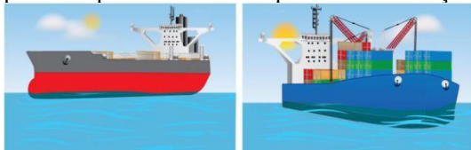
Figura 2 – Um navio descarregado flutua mais alto na água do que um navio carregado.
