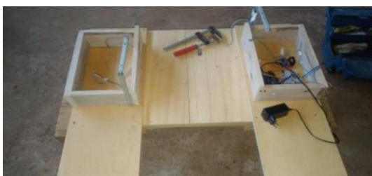
Figura 20 - Fixação das duas pilastras de tráfego terrestre na base maior de madeira da passagem de embarcações.
