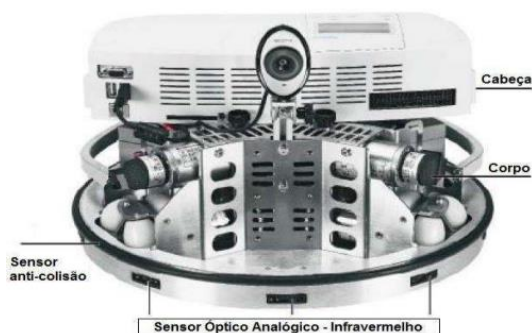
Figura 3 - Sensores localizados no corpo do Robotino.
