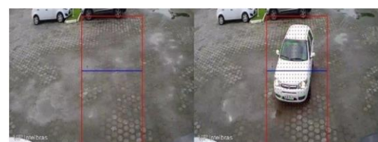
Figura 3 - Método de subtração de imagens aplicado.
