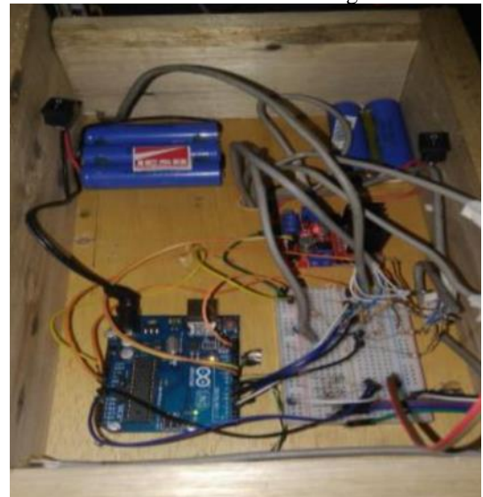
Figura 29 - Arduino alimentado por baterias e ligado a eletrônicos.
