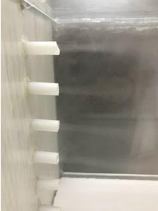
Figura 6 - Feixes de fumaça no momento de saída dos tubos; autoria própria.
