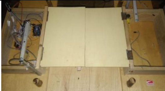
Figura 18 - Portas metálicas para o posicionamento dos semáforos e dobradiças necessárias ao movimento de subida e descida da ponte.
