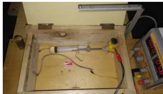
Figura 24 - Seringa com movimentação do eixo do parafuso sem fim interligado ao motor DC.
