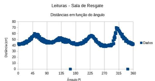
Figura 3 - Leituras do Sensor - Distâncias em função do ângulo
