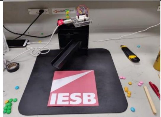
Figura 9 - Teste de identificação das cores dos doces (M&M's).
