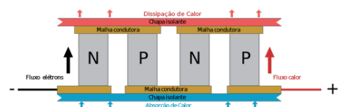
Figura 1 - Funcionamento da célula peltier.
