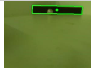
Figura 4 - Detecção da área de resgate com vítima prateada obstruindo a visão
