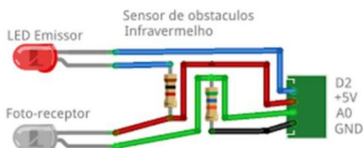
Figura 16 - Esquema eletrônico de Sensores reflexivos Infravermelhos LED Receptor e Foto- Receptor.
