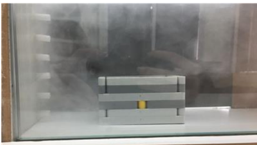
Figura 7 - Túnel de vento em funcionamento com paralelepípedo feito de lego; autoria própria.
