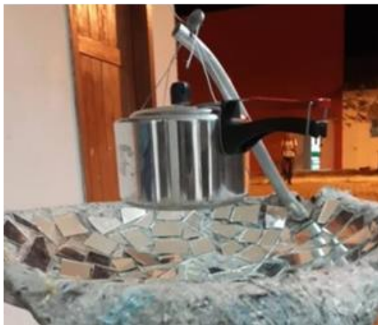
Figura 1 - Concentrador solar parcialmente desmontado com caldeira fixada em ponto focal. Fonte: Os autores.
