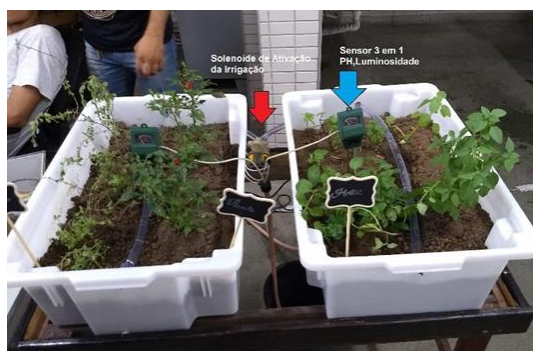
Figura 6 - Sensor 3 em 1 e solenoide de irrigação.
