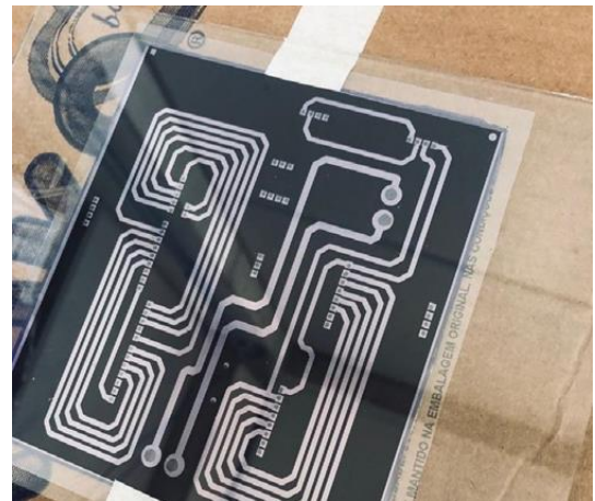
Figura 8 - placa com o desenho da face de baixo do circuito após ser exposta a luz ultravioleta.
