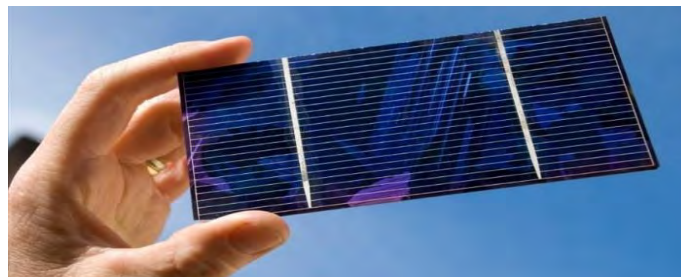
Imagem 2.1.7 – Referente uma mini- célula solar de 4,5 v.
