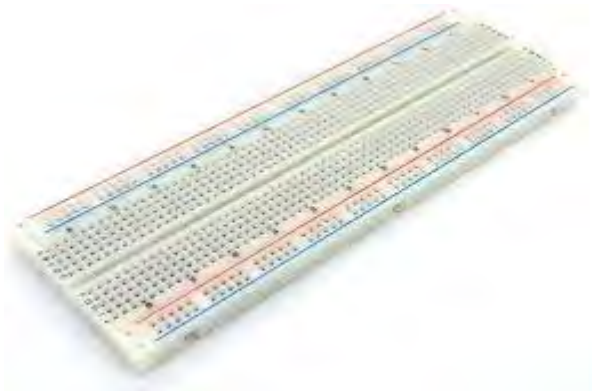
Imagem 2.1.6 – Referente Protoboard nosso modelo contém 80 'pinos.
