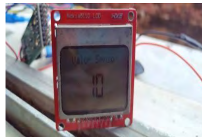
Figura 21 - Testando o sensor conectado na placa de Arduino nano e display mostrando Índice-UV 10 com classificação de nível muito alto de exposição
