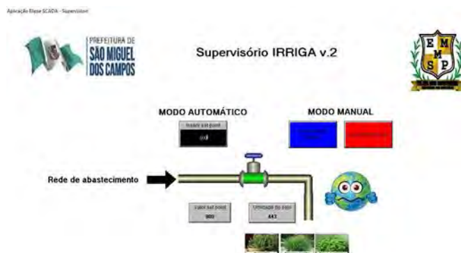
Figura 7: Supervisório mostrando que o solo está seco e sendo irrigado.
