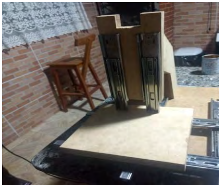
Figura 2. Fixação dos Trilhos na CNC
