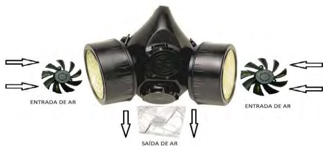
Figura 5. Fluxo de Ar no respirador
