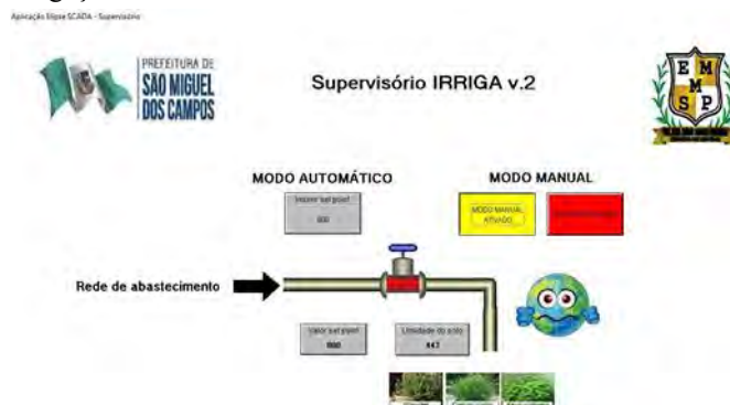
Figura 8: Protótipo operando no modo manual.
