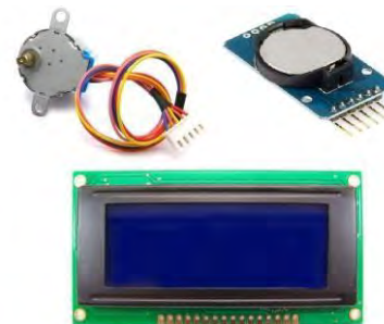
Figura 2 – Motor de passo, Módulo RTC e Display 20x4.
