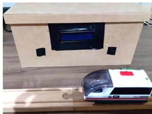
Figura 4. Posicionamento dos sensores e o trilho.
