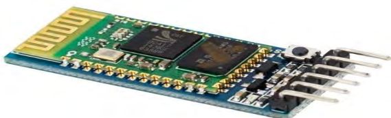
Imagem 05. Módulo Bluetooth modelo RS232 Hc-05
