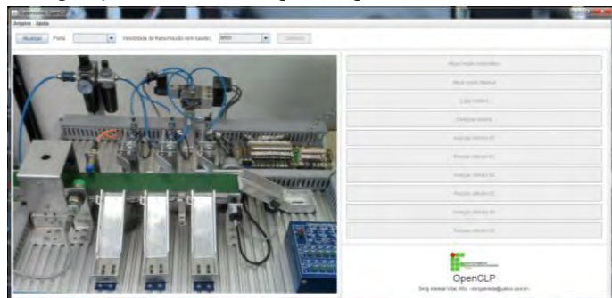
Figure 9 – O sistema supervisor desenvolvido. Fonte: Próprio autor, 2020.
