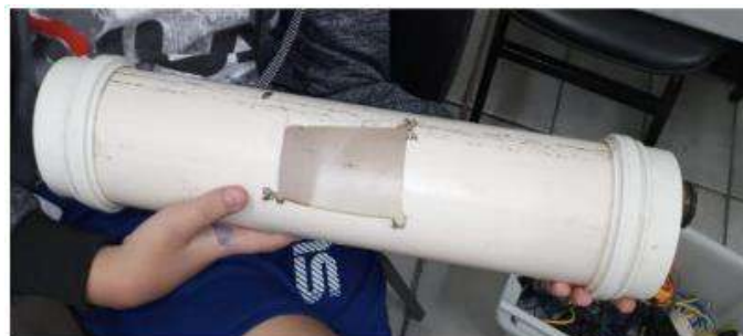
Figura 5 - Cano com abertura para introduzir a bomba.
