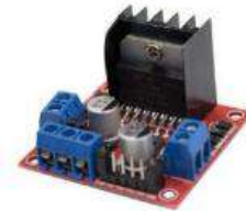
Figura 6 - Ponte H L298 para acionamento do motor.
