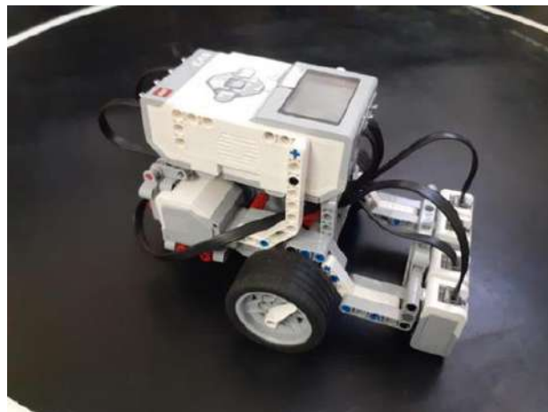
Figura 1 - Robô diferencial seguidor de linha com quatro sensores infravermelho e dois encoders.
