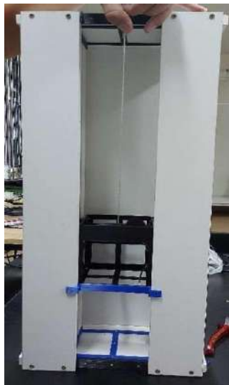
Figura 3 - Teste do funcionamento da cabine do elevador.
