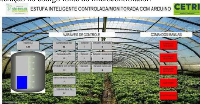
Figura 11 - Interface homem-máquina construída para acompanhamento e manipulação.
