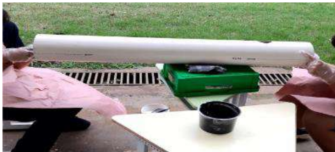
Figura 4 - Tubo PVC de 6 polegadas sendo pintado com tinta bate pedra.
