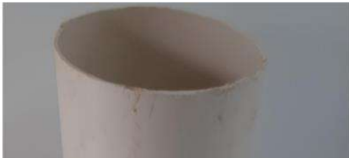
Figura 3 - Tubo PVC de 6 polegadas.
