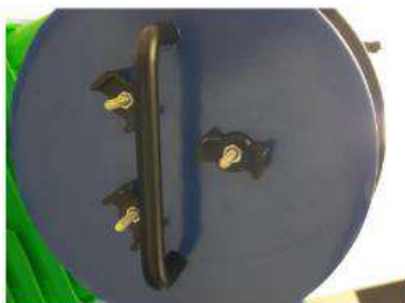
Figura 11 - tampa de tubo PVC de 6 polegadas com alça para fixação da célula do espelho primário.
