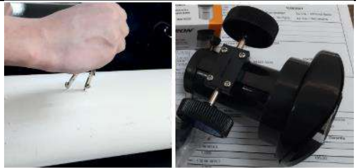
Figura 5 - Medida para corte do diâmetro do focalizador.
