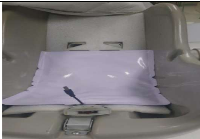
Figura 1 – Manta sensível a pressão na cadeira de bebê
