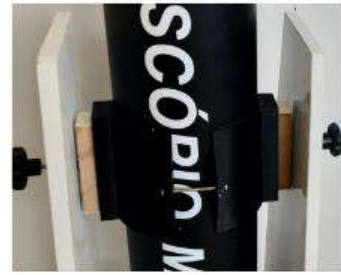
Figura 18 - montagem Dobsoniana com sistema de parafusos tipo roseta para fixação do telescópio.
