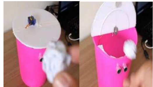
Figura 10 – Funcionamento do sensor e do servo motor para abertura da tampa.
