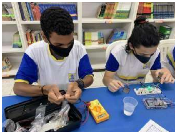
Figura 3 – Estudantes testando o resistor com o multímetro e fazendo LED acender a partir do sensor de chuva.
