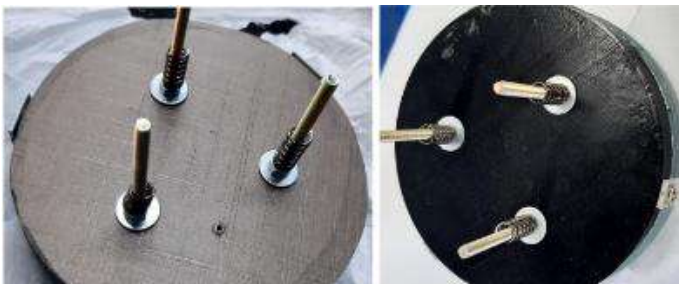
Figura 9 - Comparação: célula do espelho primário já montada feita manualmente com serra tico-tico e em 3D.
