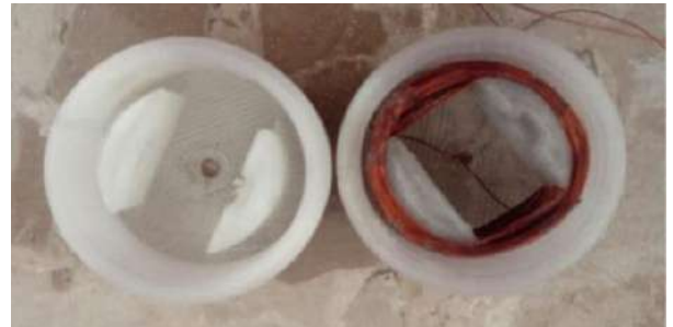
Figura 3 – Propulsor MIC: alojamento para bobina eletromagnética.
