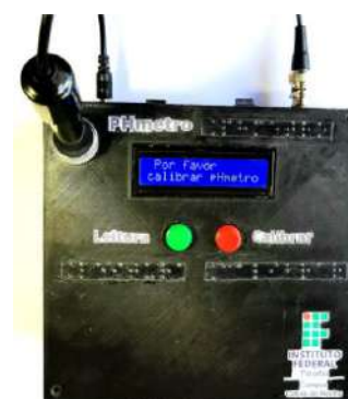
Figura 1 – Primeiro protótipo do pHmetro vocalizado.
