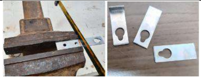
Figura 12 - chapinha de metal cortada na morça para segurar a lente objetiva.
