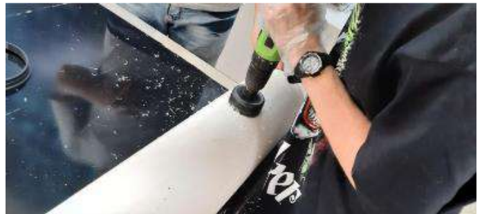
Figura 6 - Corte com serra copo da circunferência para fixação do focalizador.
