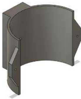
Figura 17 - modelagem em 3D da alça que sustenta o telescópio (são duas peças colocadas em sentido inverso e parafusadas com parafusos e porcas de 4mm com 7cm de comprimento).
