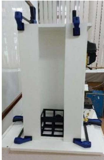
Figura 2 - Processo de montagem da parte mecânica sendo posicionada com auxílio de grampos sargentos.
