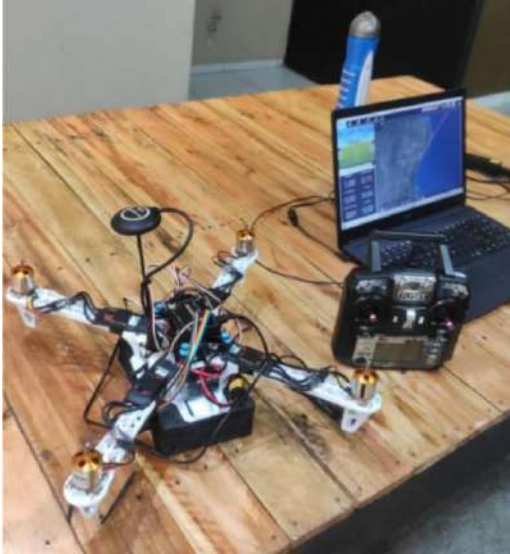
Figura 5 - Calibração do projeto pelo mission planner (Autor).
