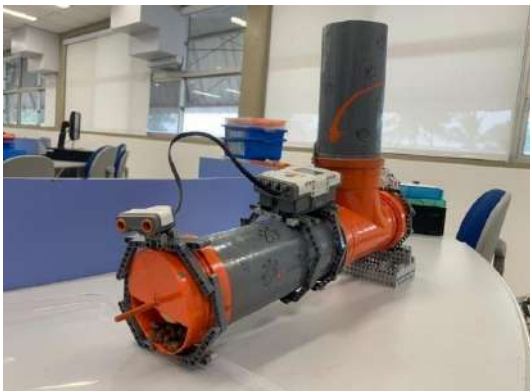
Figura 3 - Sensor e motor acoplado ao dispositivo
