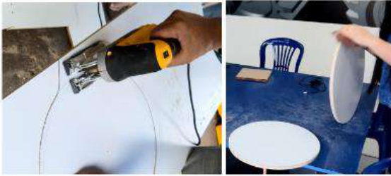
Figura 15 - corte dos MDFs em círculos com serra tico tico.
