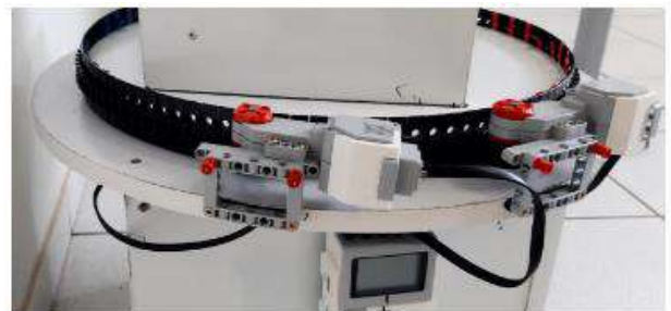
Figura 20 - sistema de esteira do EV3.
