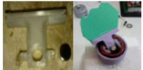
Figura 4 – Propulsor MIC: dobradiça e propulsor MIC montado com todos os componentes.
