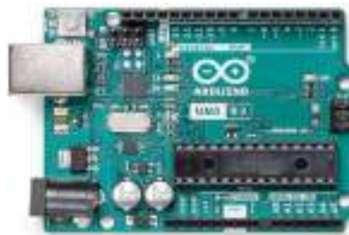
Figura 1 - Placa Arduino Uno com microcontrolador ATMEGA328P.
