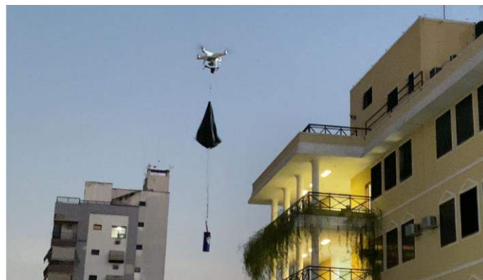
Figura 8 – LaSalleSat sendo alçado por drone.
