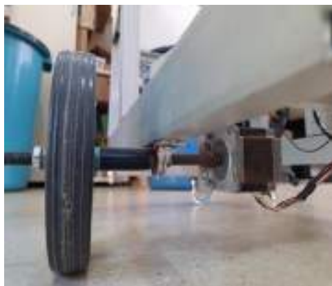
Figura 07 - Acoplamento entre a roda e rotor do motor.
