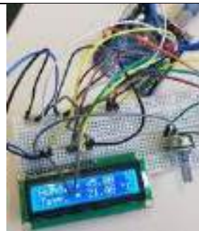
Figura 6: Teste de ligação de tela LCD em placa de ensaio e Arduino anterior à fixação na base do protótipo.
