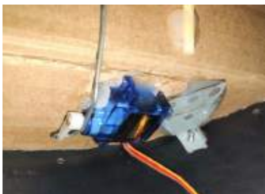
Figura 3 – Servo motor acionado – abertura da lixeira
