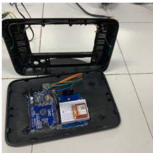
Figura 2 - Montagem do projeto reutilizando equipamentos de sucata.
