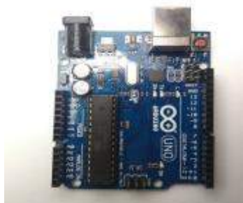
Figura 6 – Placa Arduino UNO R3 com microcontrolador ATMEGA328.
