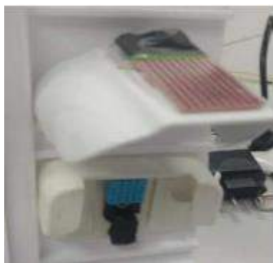
Figura 3 - Sensores de umidade, temperatura e pluviosidade instalados na área externa em contato com o ambiente.
