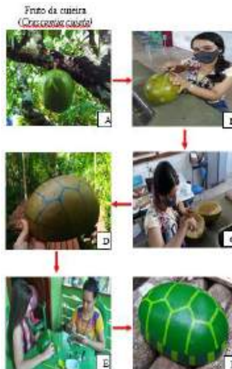
Figura 16. Sequência de etapas dado a cuia para transformá-la em carenagem do robô, (A) Fruto na cuieira ( Crescentia cujete ), (B) Marcação e corte do fruto em duas bandas, (C) Retirada da massa interna da cuia (D, E e F) Pintura
