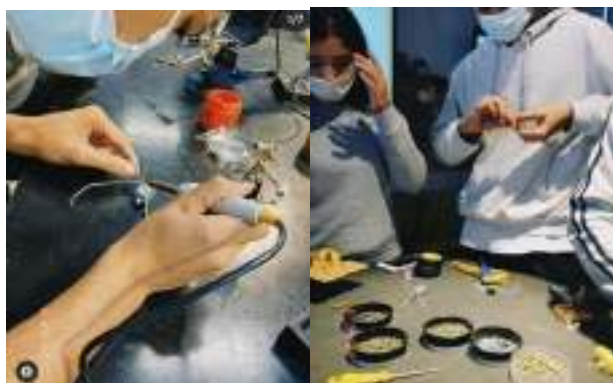
Figura 6: (a) grupo soldando os fios nos respectivos motores. Fonte: autoria própria.
