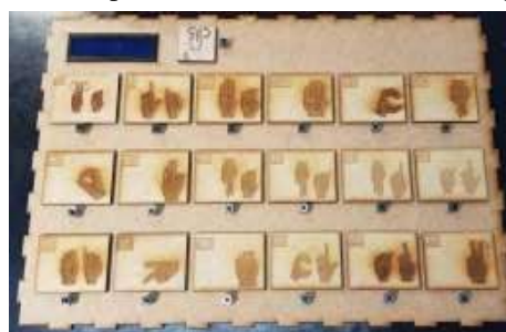
Figura 7: Fixação da tela de LCD na base da tabela inclusiva. Botões sendo posicionados para corte à laser.
