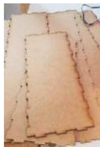
Figura 4: Caixa cortada para montagem do protótipo (peças dos elementos químicos em LIBRAS e parte tecnológica)
