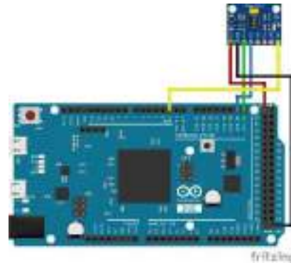
Figura 2 – Conexões do MPU6050 com o arduino Due.
