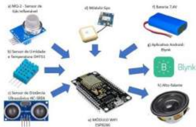
Figura 1 - Diagrama de Blocos de Funcionamento do capacete inteligente dotado de estação de sensores e comunicação wi-fi.
