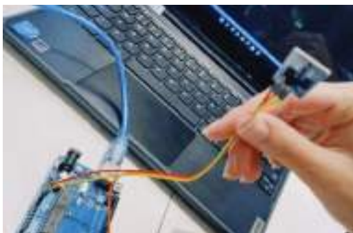
Figura 10: Vista da ligação esquemática entre Arduino e sensor de infravermelho. Fonte: autoria própria.
