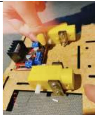
Figura 7: Posicionamento dos motores (em amarelo) e do controlador de motor (Ponte H) no chassi do robô. Fonte: autoria própria.
