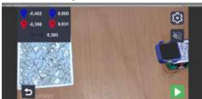
Figura 10 - Tela da aplicação atual com os robôs real (verde) e virtual (azul) sendo identificados e analisados.
