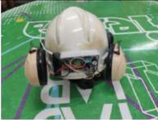
Figura 3 - Protótipo da estação de sensores vestíveis conectados à rede wi-fi para equipamento
