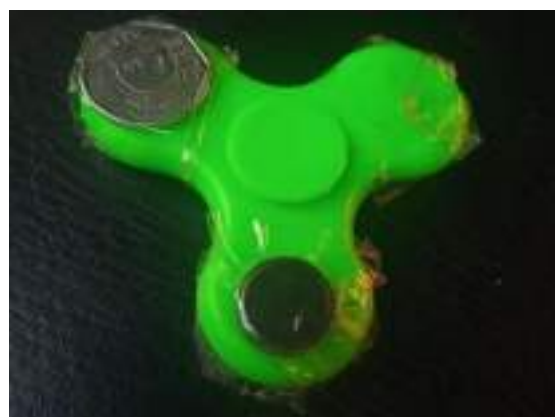
Figura 2 - Aparato de ímã grudado ao fidget spinner.
