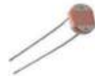
Figura 2 - Sensor de Luminosidade LDR.
