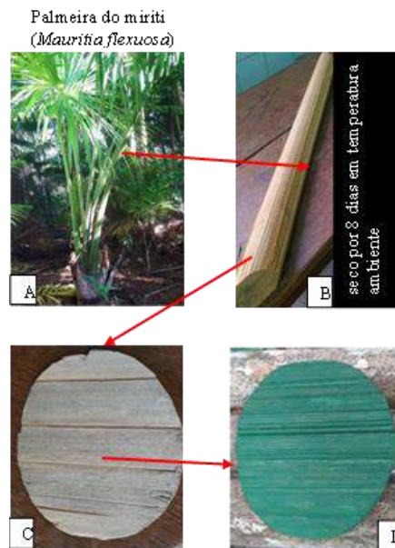
Figura 15. Sequência de procedimentos dado ao miriti para construir o chassi do robô, (A) Palmeira do miriti, (B) “Braço” (fibra) do miriti seco, (C) Estrutura do chassi em miriti e (D) Estrutura do chassi em miriti pintada.
