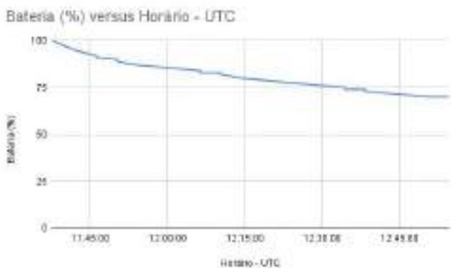
Figura 14 -Gráfico esquemático com os dados do nível de bateria e o horário de envio.
