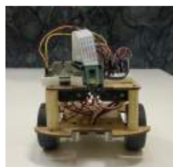
Figura 3- Posicionamento da PiCam em relação à plataforma robótica
