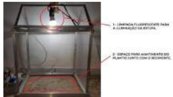
Figura 3 - Estrutura da estufa
