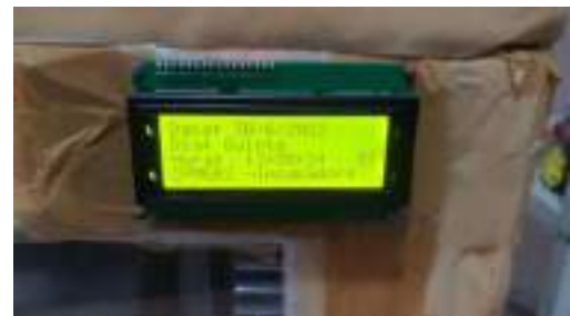
Figura 5 – Display LCD 20x16 apontando data e hora local. Fonte: Imagem produzida pelos autores, 2021.
